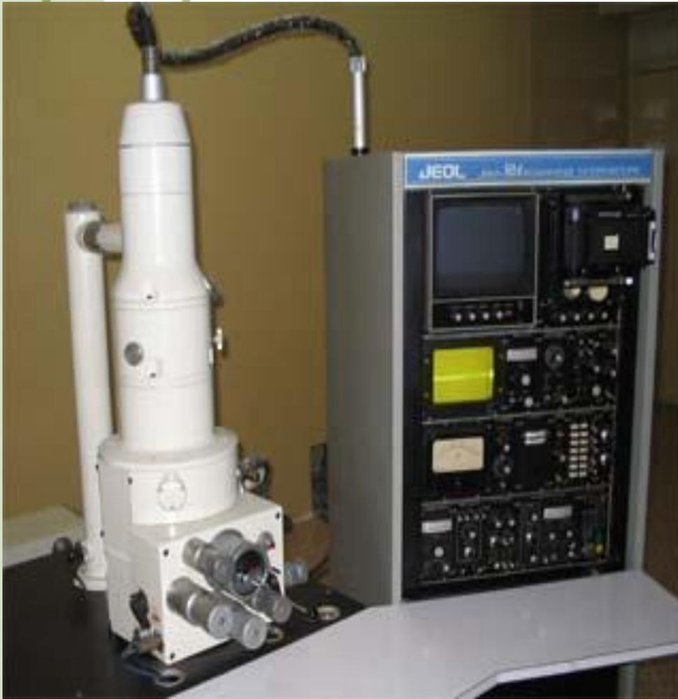
**Сканирующий электронный микроскоп:**
