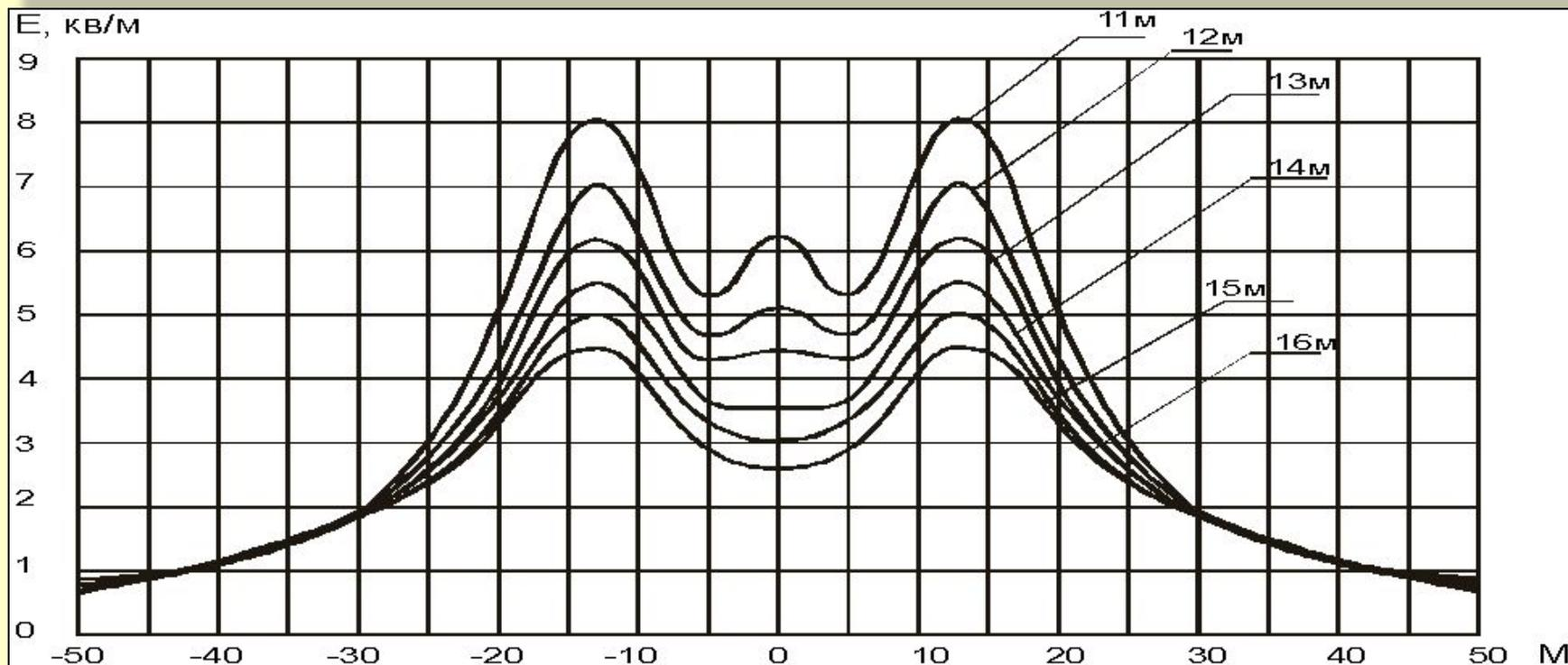
**Распределение напряженности электрического поля в сечении на ВЛ – 500 кВ на уровне 1,8 м от поверхности земли в зависимости от габарита „нижний провод фазы – земля”.**
