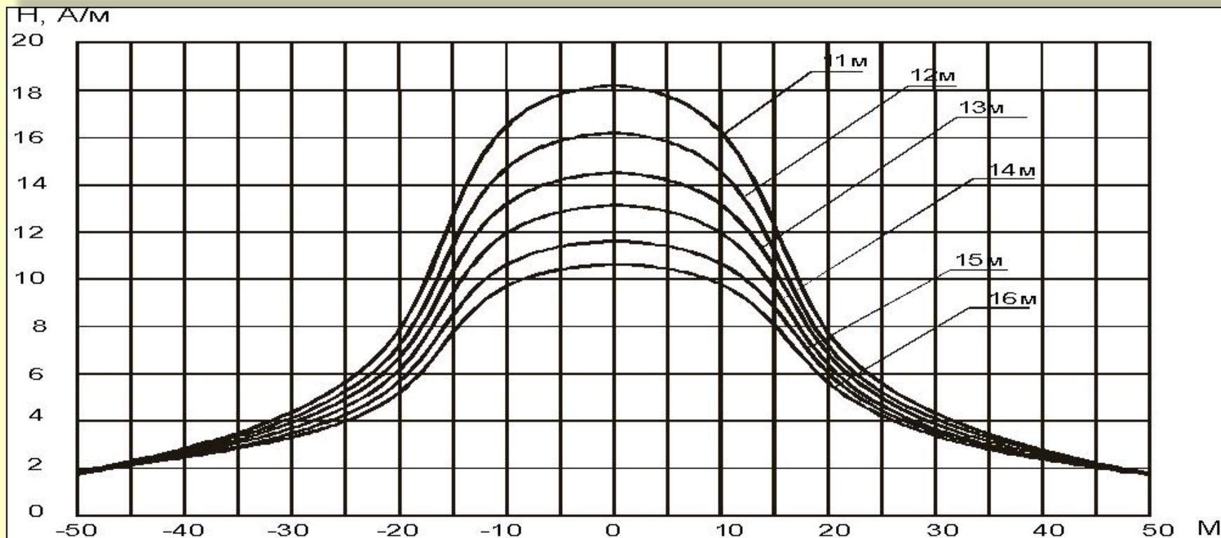
**Распределение напряженности магнитного поля в сечении на ВЛ – 500 кВ на уровне 1,8 м от поверхности земли в зависимости от габарита «нижний провод фазы – земля».**
