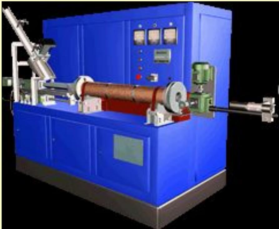
Индукционные установки **ИНТ9-250/2,4**, **ИНТ1-500/2,4** и **ИНТ2-500/1** предназначены для нагрева мерных заготовок круглого сечения перед пластической деформацией в кузнечнопрессовом производстве.
