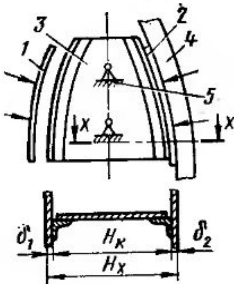
1-обшивка (панель) до установки на каркас; 2 – обшивка установленная на каркас; 3- каркас; 4- элементы сборочного приспособления, прижимающие обшивку к каркасу; 5- фиксация каркаса с сборочным приспособлении
