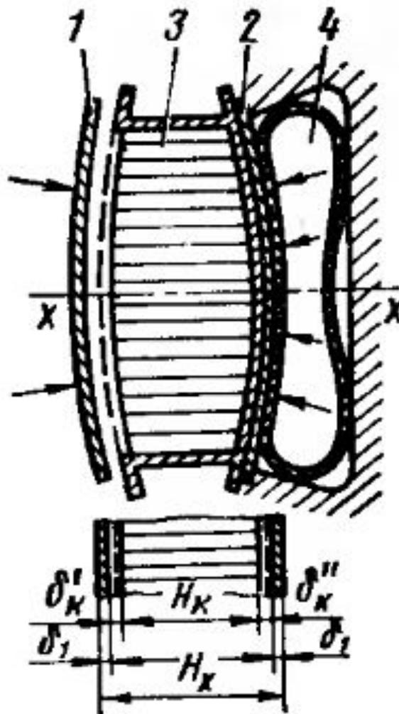
где 1-обшивка, 2-слой клея(припой), 3- соты, 4- элементы сборочного приспособления, прижимающие обшивку к каркасу
