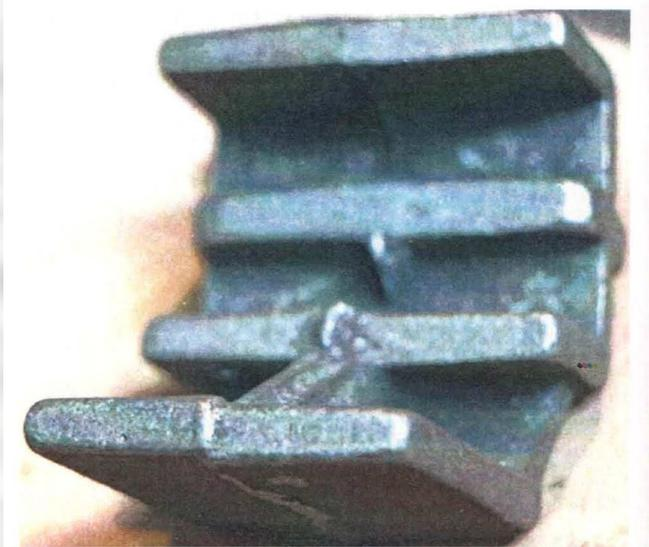
*Отливка «Кронштейн со смещением половинок модели*
