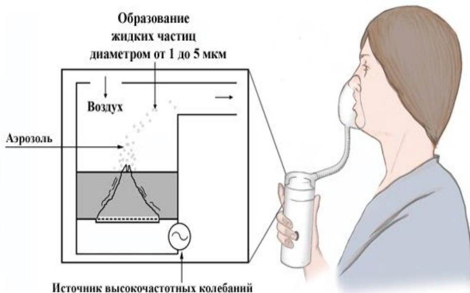
Схема ультразвукового небулайзера
