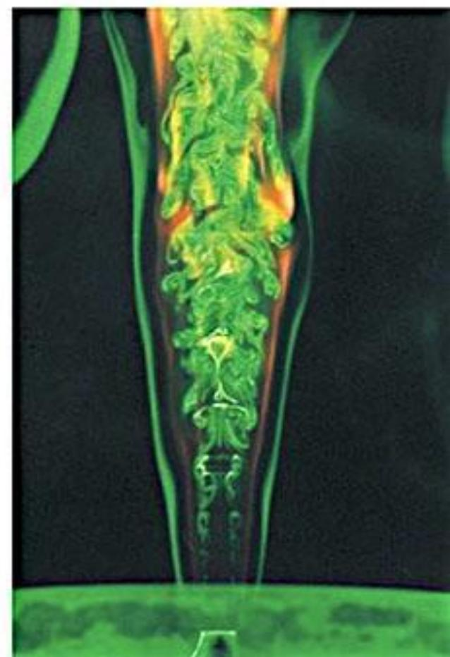
Газодинамический режим горения зависит от линейной скорости горючего вещества или смеси и характеризуется критерием Рейнольдса (мера отношения сил инерции и внутреннего трения в потоке):
