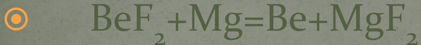
В настоящее время бериллий получают, восстанавливая его фторид магнием, либо электролизом расплава смеси хлоридов бериллия и натрия.
