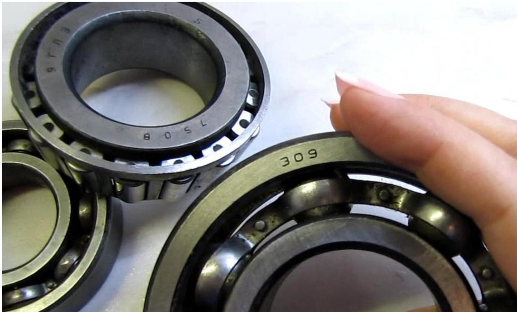
Условные обозначения подшипника обычно наносят на торце наружного кольца. Можно увидеть маркировку, состоящую из цифр и букв. Маркировка подшипников
