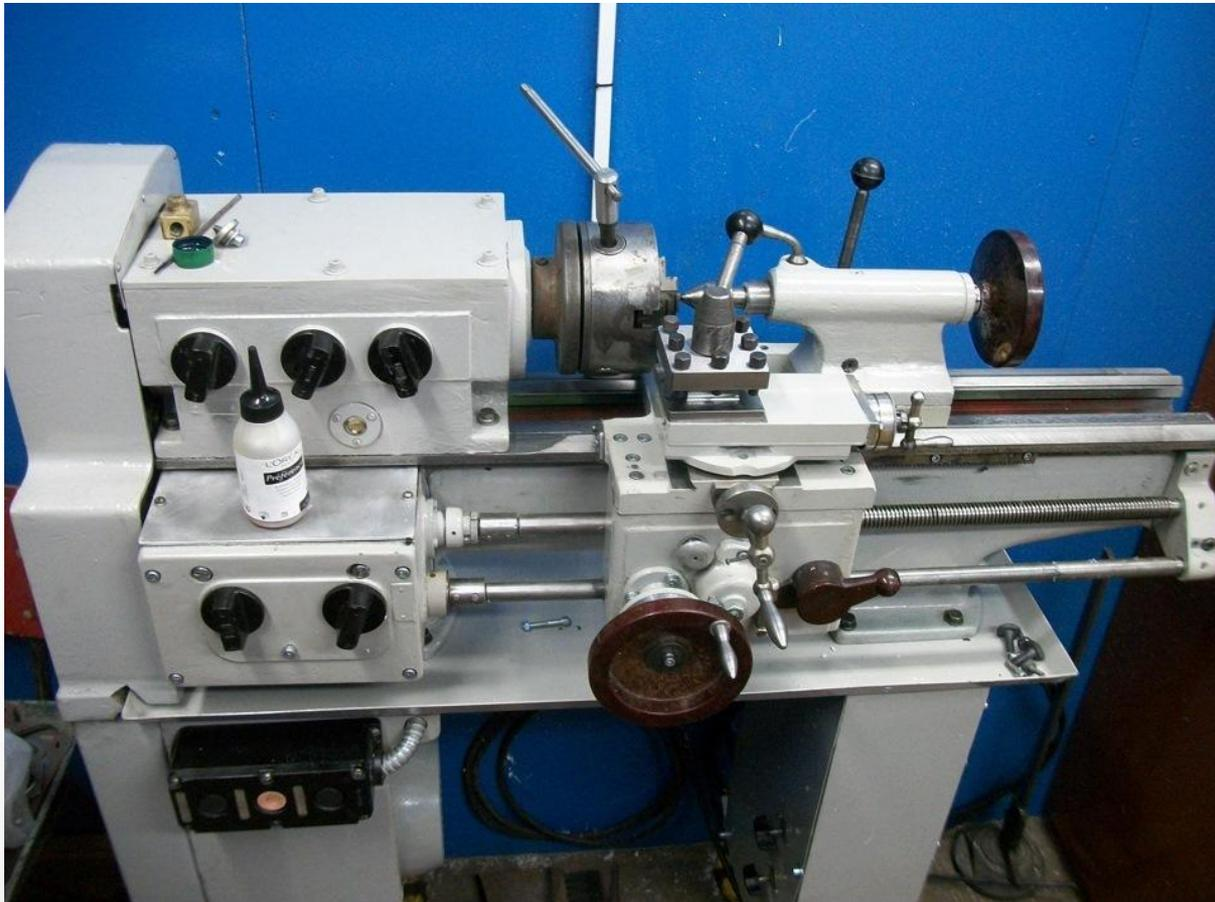
**Наибольший диаметр** обрабатываемого металлического прутка — 12 мм, **наибольший диаметр изделия**, устанавливаемого над станиной, — 200 мм, **наибольшая длина** обтачивания — 300 мм.
