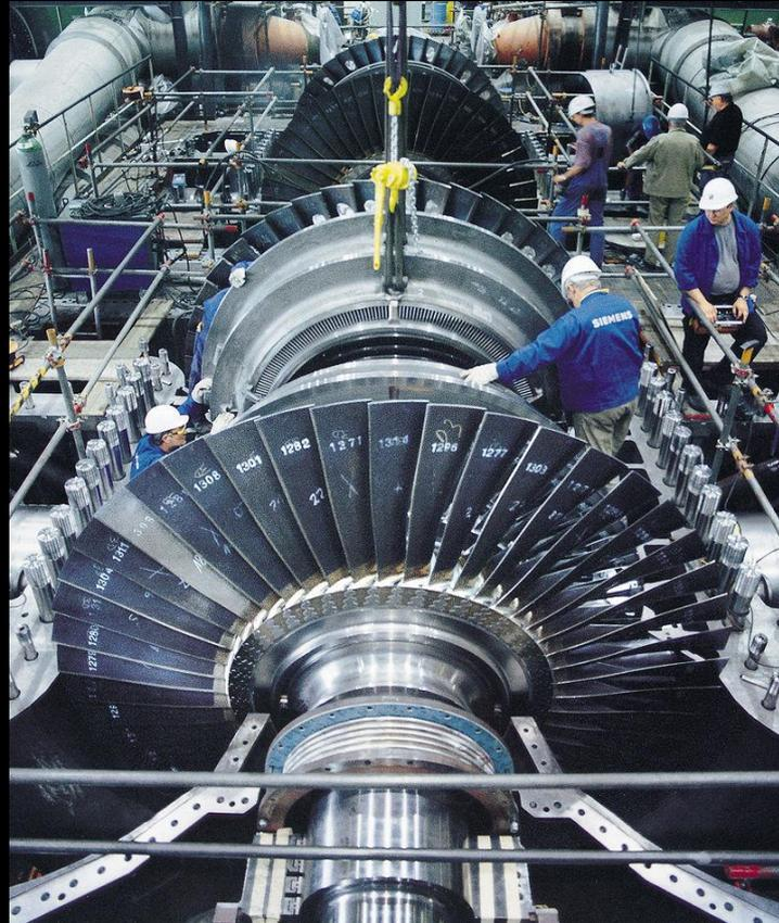
Монтаж ротора паровой турбины, производства компании Siemens, Германия
