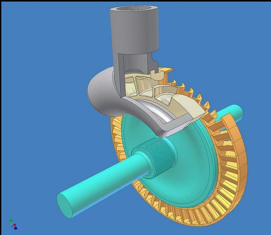
Модель одной ступени паровой турбины
