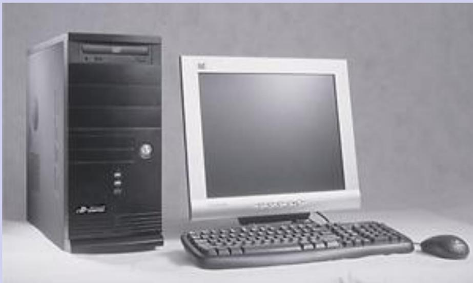
ПЭВМ семейства Secret являются модификацией серийных ПЭВМ, доработанных специальным образом для повышения характеристик защищенности обрабатываемой на них информации от утечки по техническим каналам за счет побочных электромагнитных излучений и наводок (ПЭМИН) и НСД.
