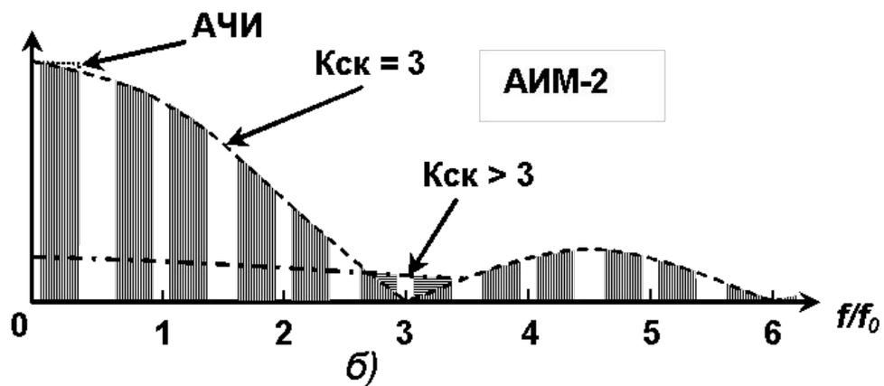
Спектры сигналов: при АИМ-1 (а), при АИМ-2 (б)
