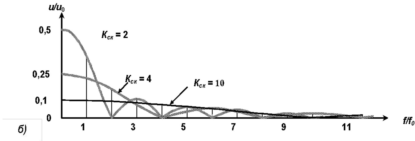
Последовательность прямоугольных импульсов (а) и спектральный состав таких последовательностей с различными  $K_{CK}$  (б)
