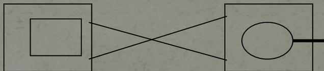
2. **Сцепка треугольником** – применяется при наличии у тягача центрального буксирного устройства.
