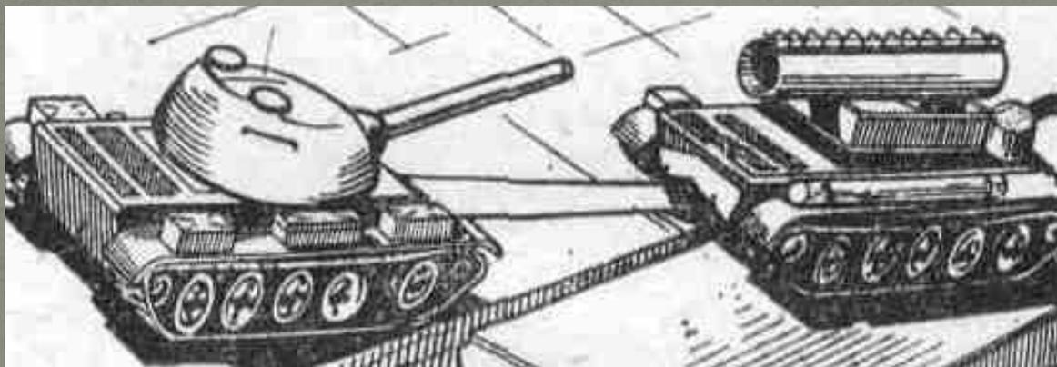
Сцепка застрявшей машины с тягачом производится буксирными тросами.
