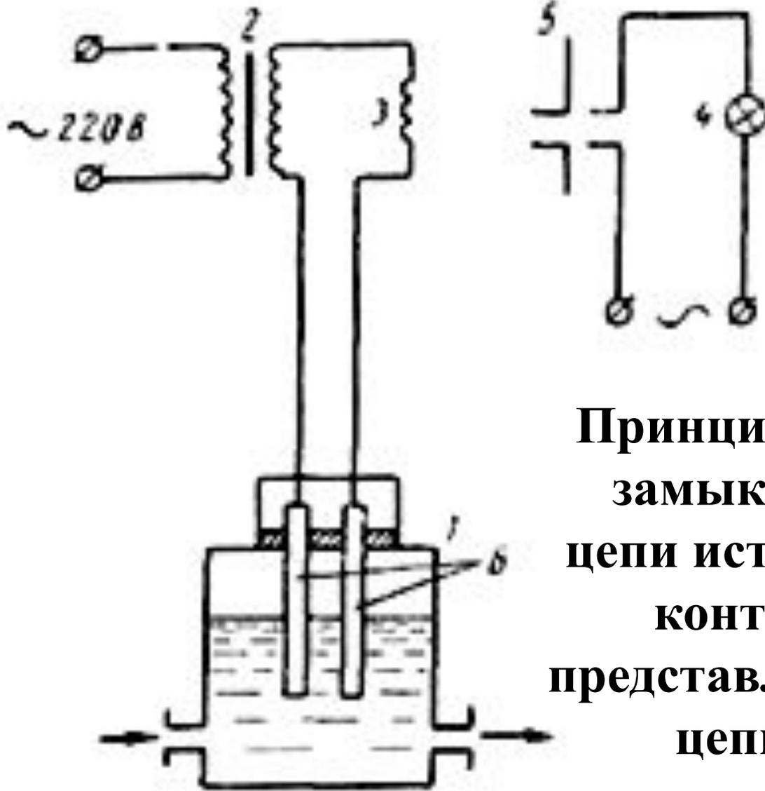
**Принцип действия основан на замыкании электрической цепи источника питания через контролируемую среду, представляющую собой участок цепи с определенным омическим сопротивлением**
