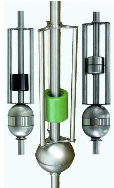
Поплавок из магнитного материала, который скользит вверх и вниз вокруг герметизированной от жидкости трубки. В трубке находится постоянный магнит, который может перемещаться вверх и вниз вслед за поплавком и через рычаг перемещает стрелку по шкале
