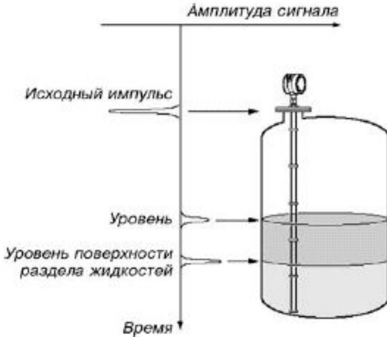
**Радарные импульсы малой мощности направляются вниз по зонду, погруженному в измеряемую среду.**
