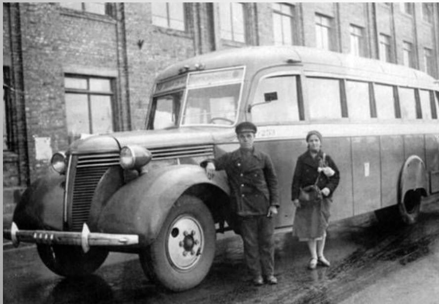
Автобус вмещал до 34 пассажиров (при 26). Форсированный примерно до 84 л.с. двигатель ЗИС-16 разгонял машину полной массой 7,13 т до 65 км/ч.
