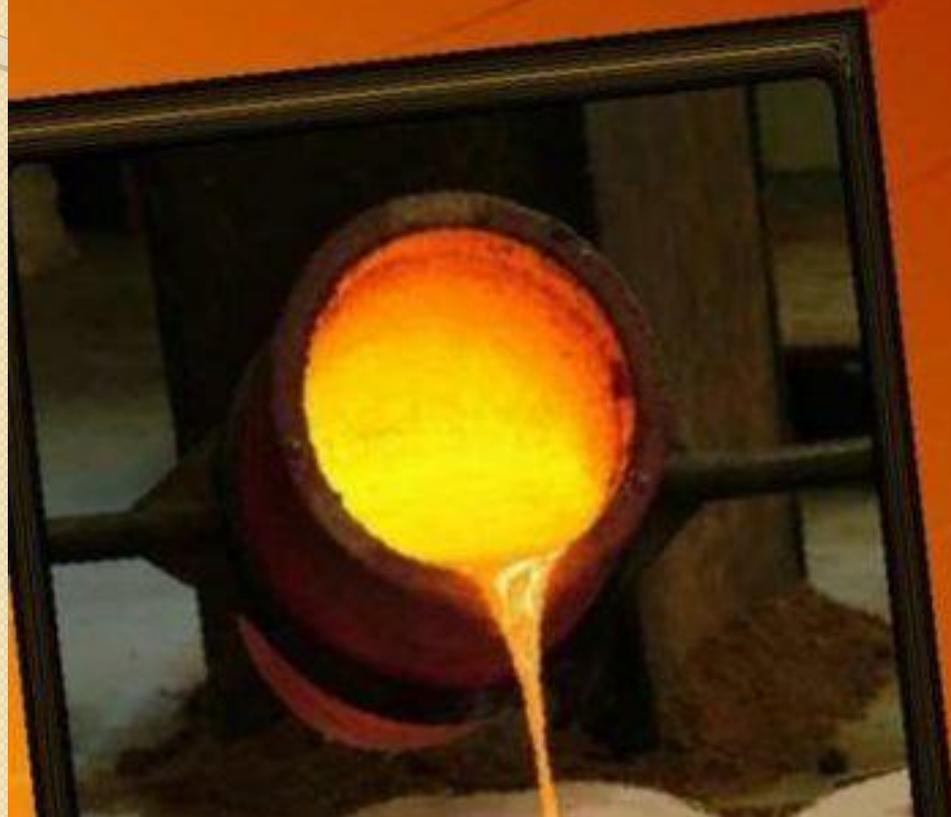
Сначала изготавливаются деревянные шаблоны, а на их базе песчаные формы. После этого в песчаную форму заливается расплавленный металл, который постепенно застывает. При удалении полученной отливки форма разрушается.
