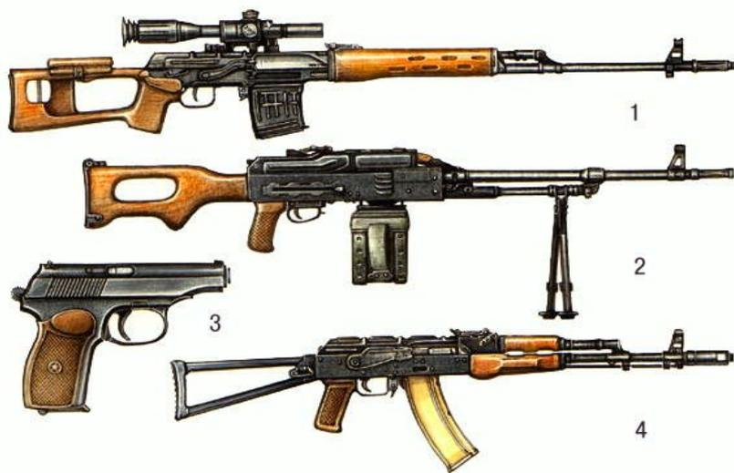
Автоматическое оружие: 1 — самозарядная снайперская винтовка системы Драгунова образца 1963 (СВД); 2 — единый пулемет системы Калашникова образца 1961 (ПКМ); 3 — самозарядный пистолет системы Макарова образца 1951 (ПМ); 4 — автомат системы Калашникова образца 1974 (АКС-74).
