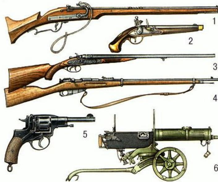
Огнестрельное оружие: 1 — фитильный мушкет 16-17 вв.; 2 — русский кавалерийский пистолет образца 1810; 3 — охотничье курковое ружье начала 20 в.; 4 — трехлинейная магазинная винтовка системы Мосина образца 1891; 5 — револьвер системы Нагана образца 1895; 6 — станковый пулемет системы Максима образца 1910.
