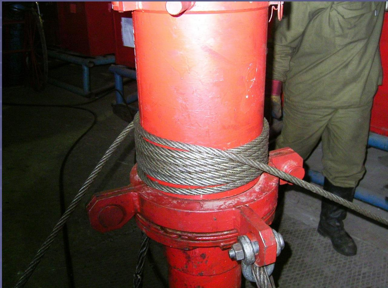
Отворот трубы осуществляется за счет сматывания каната с барабана приспособления тяговым механизмом
