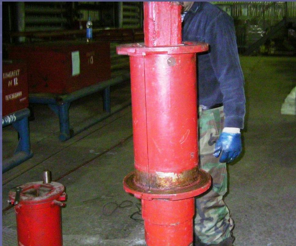
2. Установить на корпусе приспособления разъёмный сепаратор и зафиксировать фиксатором;
