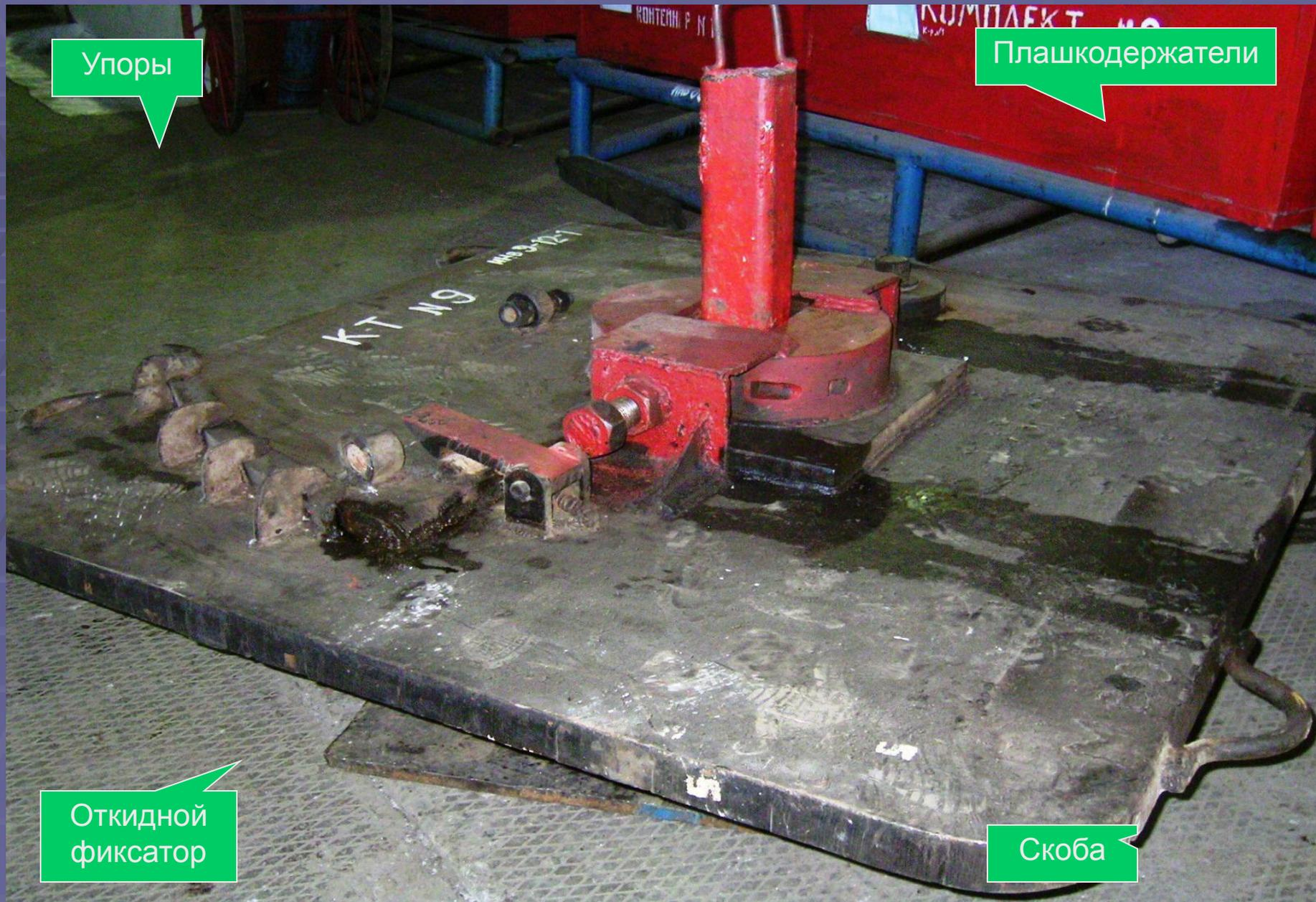
Приспособления предназначены для отворота ведущей трубы, бурильной и насосно-компрессорных труб находящейся под давлением.
