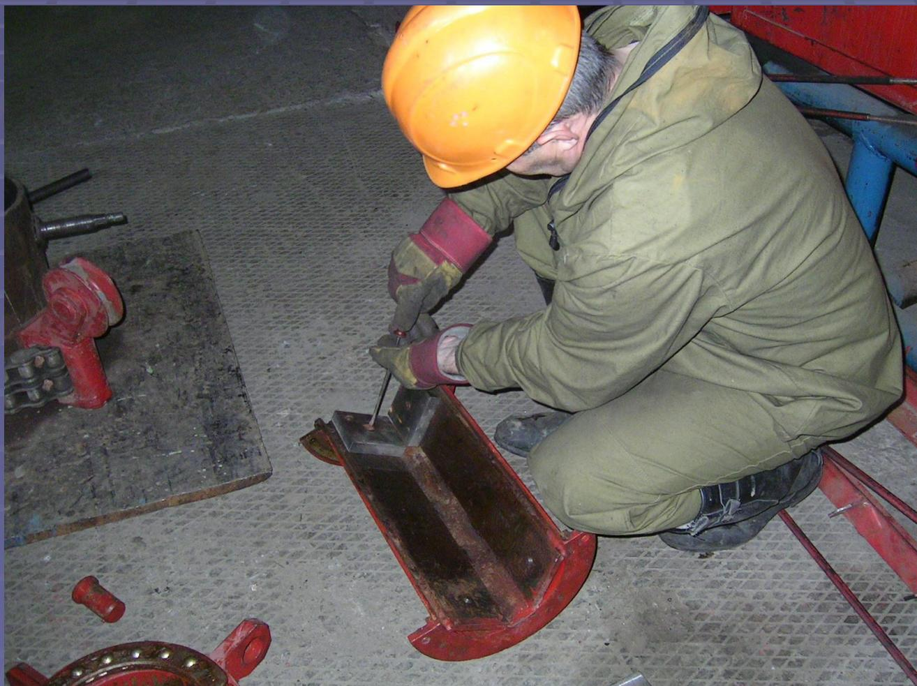
На полукорпусах в сборе устанавливается разъемный сепаратор
