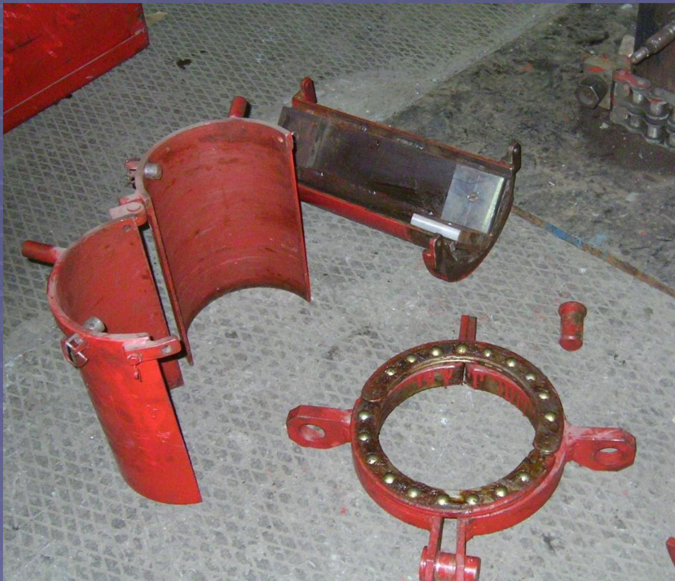
Приспособление ПОК состоит из двух полукорпусов. Для установки приспособления на различные размеры ведущих труб предусмотрена установка сменных плашек, которые крепятся винтами.
