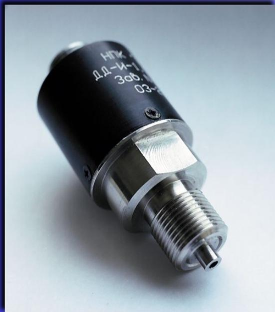
**Датчик давления предназначен для измерения избыточного давления неагрессивных сред в системах сбора данных, контроля и регулирования параметров в диапазоне от 0 до 1,0 Мпа и от 0 до 1,6 Мпа.**
