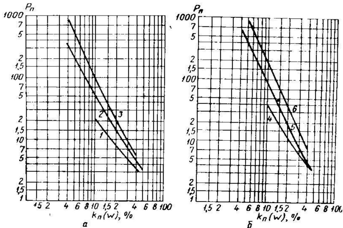
Зависимости параметра  $P_n$  от коэффициента пористости  $k_n$  (объемной влажности  $w$ ) (по В. Н. Дахнову).
