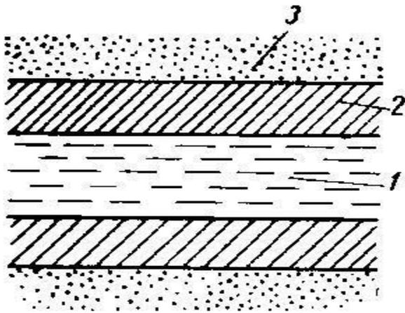
Схема расположения различных материалов в поровом пространстве сильно глинистых пород.
