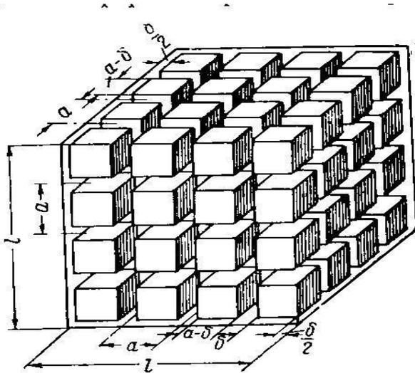
К выводу уравнения, определяющего электрическое удельное сопротивление биминеральной породы с кубическими включениями.
