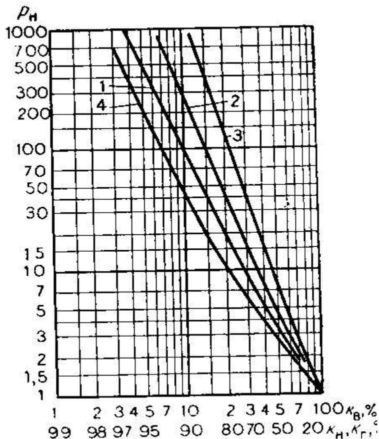
Зависимость параметра  $P_n$  насыщения от коэффициентов нефте-, водо- и газонасыщения породы.
