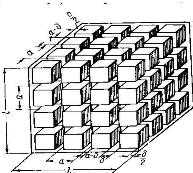
К выводу уравнения, определяющего электрическое удельное сопротивление бимодальной породы с кубическими включениями.
