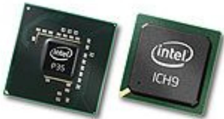
Чипсет (набор микросхем системной логики) – наиболее значимый элемент системной платы, состоящий из двух частей – северного (Northbridge) и южного (Southbridge) мостов.
