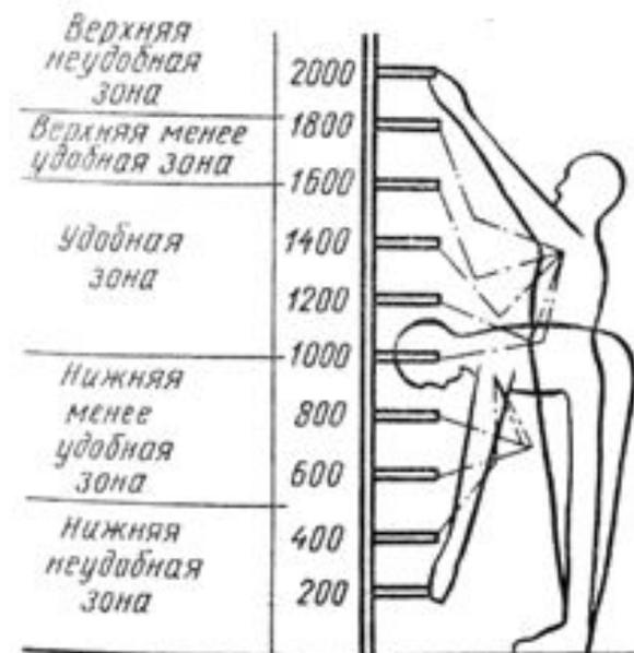
Для создания таких условий необходимо, чтобы верстак или стол, приспособления, инструменты, стеллажи, а также детали и сборочные единицы, поступающие на сборку, и техническая документация были размещены на рабочем месте следующим образом:
