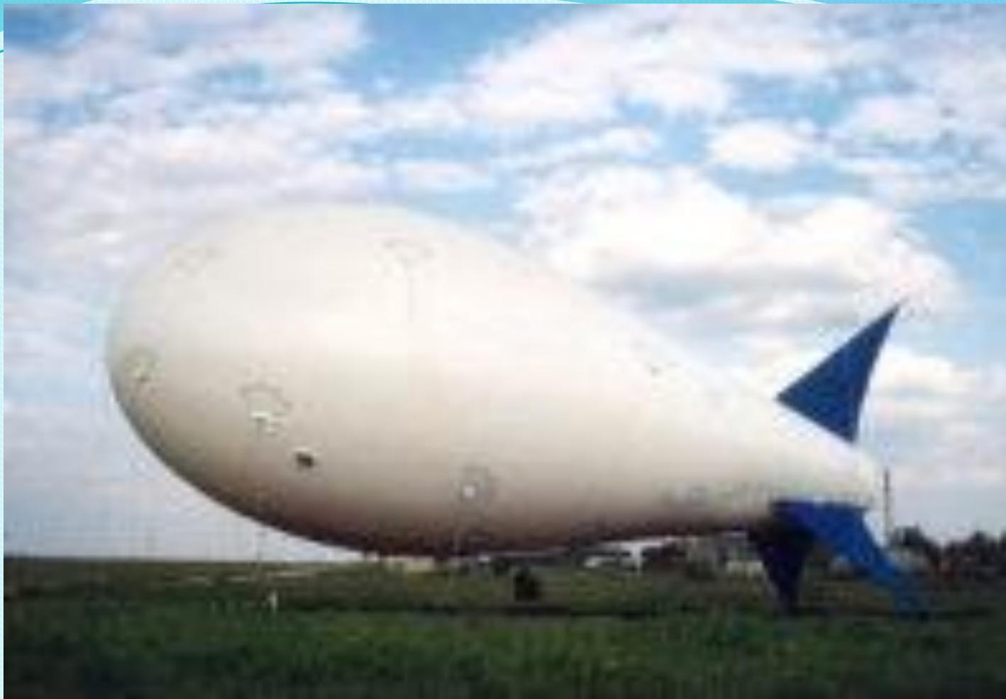
Привязной аэростат-носитель "Барс", или Au-17, имеет высокую ветровую устойчивость, что позволяет применять его при любой погоде. Он предназначен для подъёма аппаратуры, требующей постоянного энергоснабжения, а также обеспечения обмена информации с землей. Для этих целей используется специальный кабель-трос.
