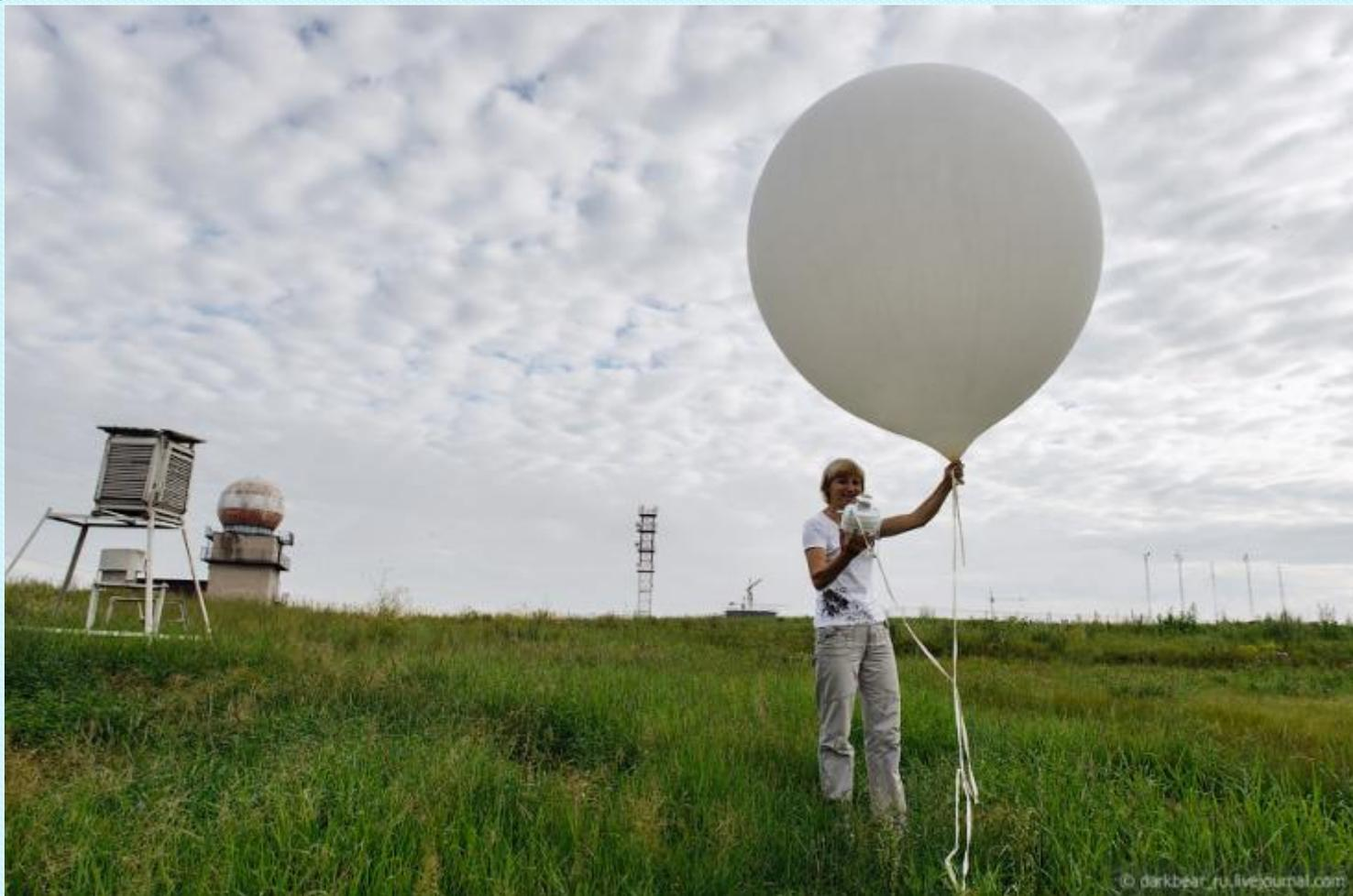
Шар-зонд. Поднимается шар на высоту 30-35 километров, а от метеостанции его может отнести ветром на 100 километров. Зонд — одноразовый прибор.
