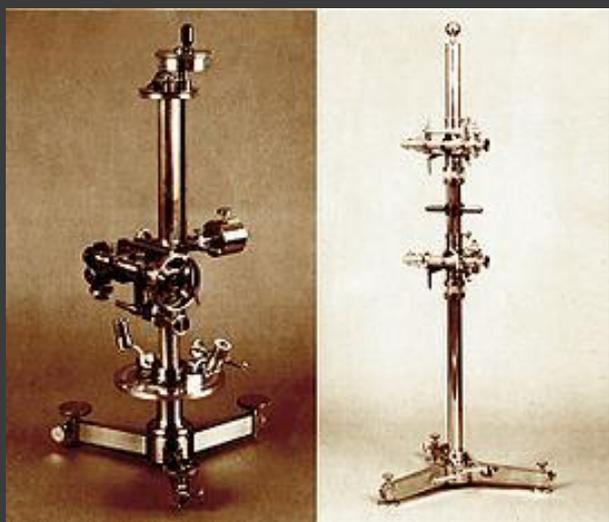
Катетометр и компаратор,
