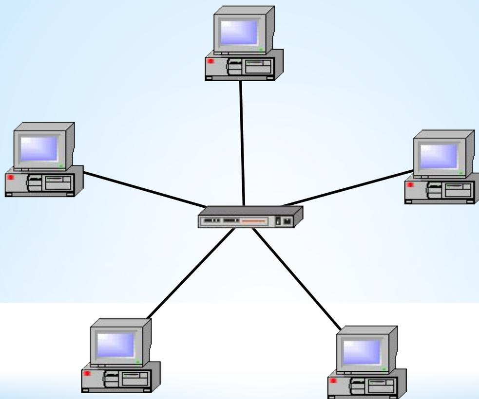
**Звезда** — топология компьютерной сети, в которой все компьютеры присоединены к центральному узлу (обычно сетевой концентратор).
