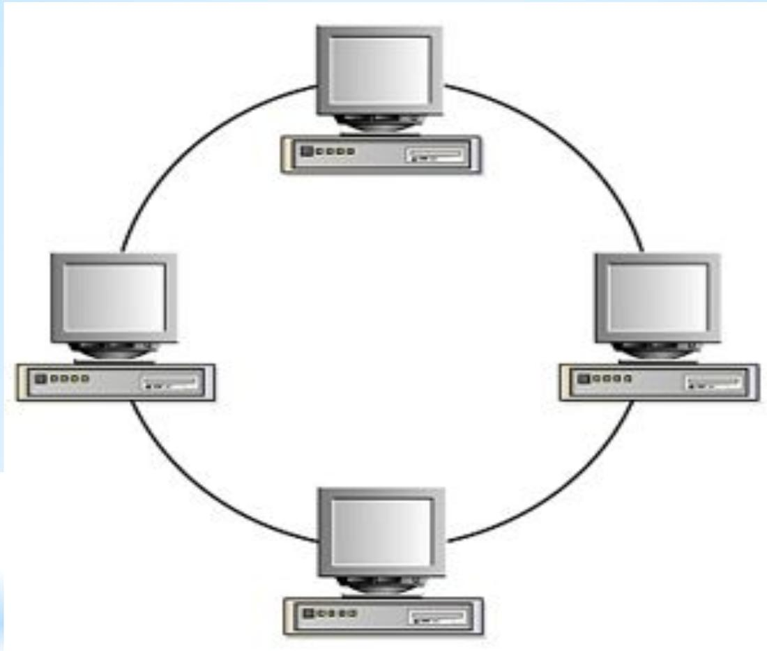
**Кольцо** — это топология, в которой каждый компьютер соединен линиями связи с двумя другими: от одного он только получает информацию, а другому только передает
