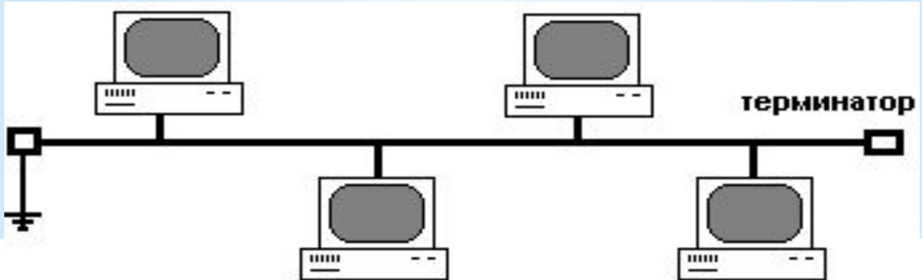
**Топология типа шина**, представляет собой общий кабель (называемый шина), к которому подсоединены все рабочие станции. На концах кабеля находятся терминаторы, для предотвращения отражения сигнала.
