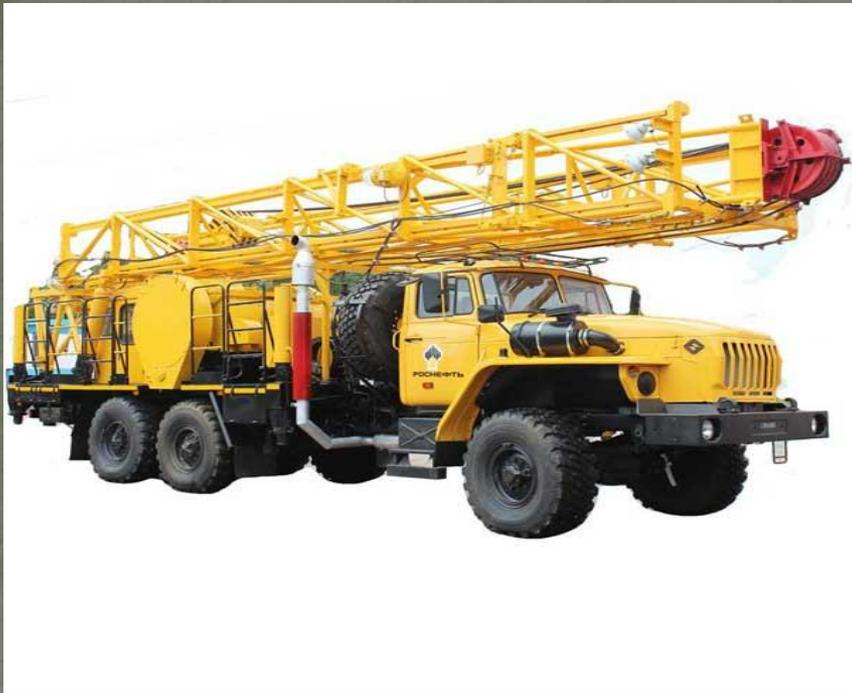
Предназначен для производства комплекса работ по текущему ремонту скважин.
