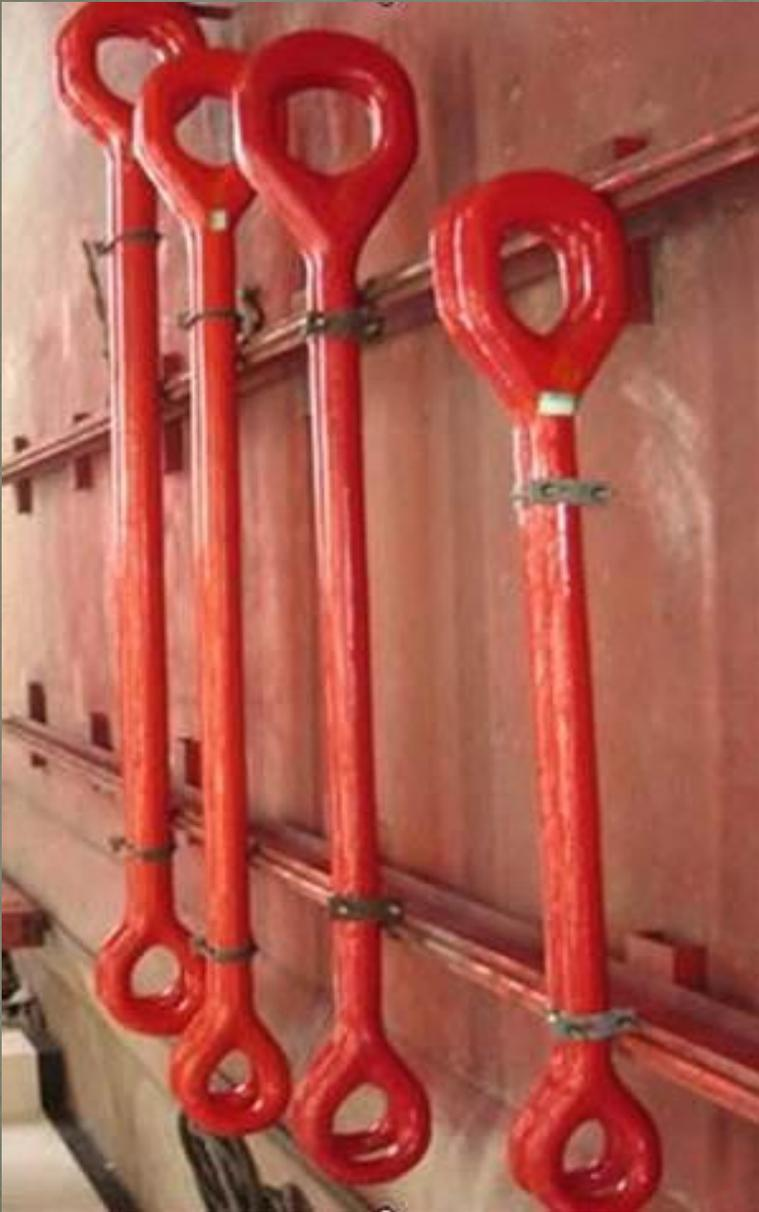
Штропы однострунные ШО предназначены для удержания на весу элеватора с колонной бурильных или обсадных труб и крепятся к крюкоблоку буровой установки. Грузоподъемность - 250 и 350 тонн.
