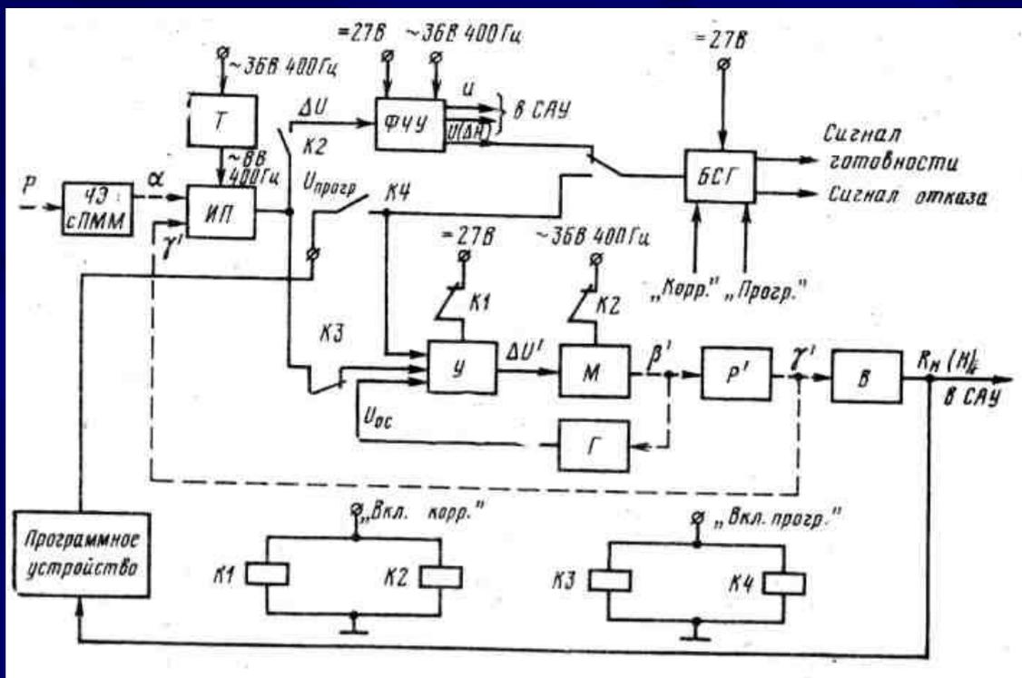
В блоке БСГ сигнал переменного тока частотой 400 Гц с выхода корректора поступает в усилитель - реле, где усиливается по двухтактной схеме усиления, выпрямляется, сглаживается емкостным фильтром и в отрицательной полярности поступает на несимметричный триггер с одним устойчивым состоянием, нагруженный на обмотку реле.
