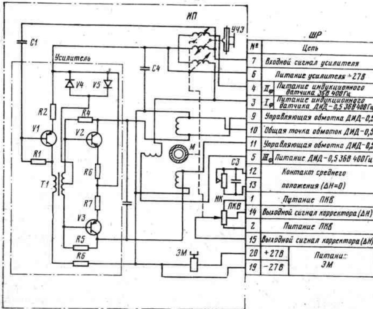
Выходной сигнал корректора высоты снимается с потенциометра **ПКВ**. Контакт **НК** сигнализатора готовности размыкается при смещении щетки потенциометра **ПКВ** от среднего (нулевого) положения.
