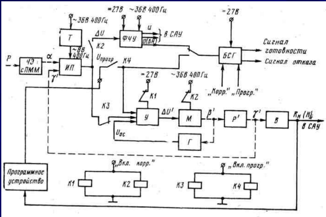
**Режимы работы.** В **режим коррекции** корректор КЗВ включается оператором или программным устройством после того, как достигнута высота стабилизации. В этом режиме питание элементов  $У$  и  $М$  отключается с помощью реле  $K1$  и  $K2$ . Сигнал рассогласования  $\Delta U$  не обнуляется и существует, пока не будет достигнуто стабилизируемое значение высоты.
