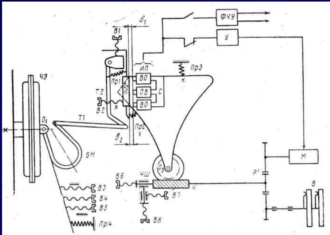
Двигатель  $M$  служит для отработки преобразователя ИП в согласованное положение, когда зазоры  $\delta_1$  и  $\delta_2$  между якорем Я и сердечником С будут равны. Усилитель У низкой частоты трехкаскадный с трансформаторной связью между каскадами. Первый каскад выполнен по схеме эмиттерного повторителя. Второй и третий каскады выполняются по двухтактной схеме.
