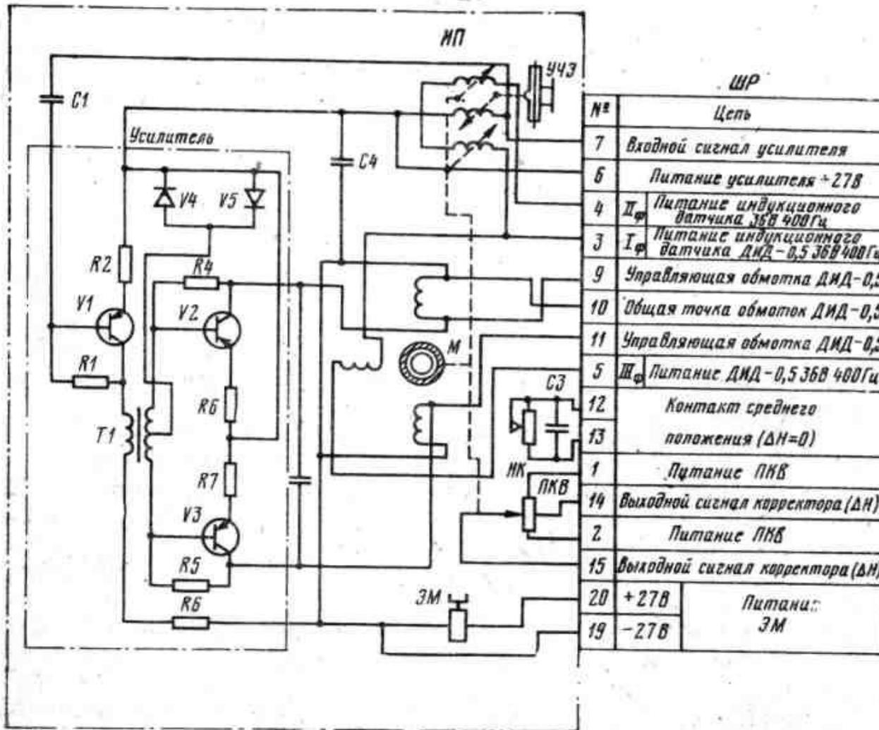
Полупроводниковый усилитель следящей системы - двухкаскадный с трансформаторной связью между каскадами.
