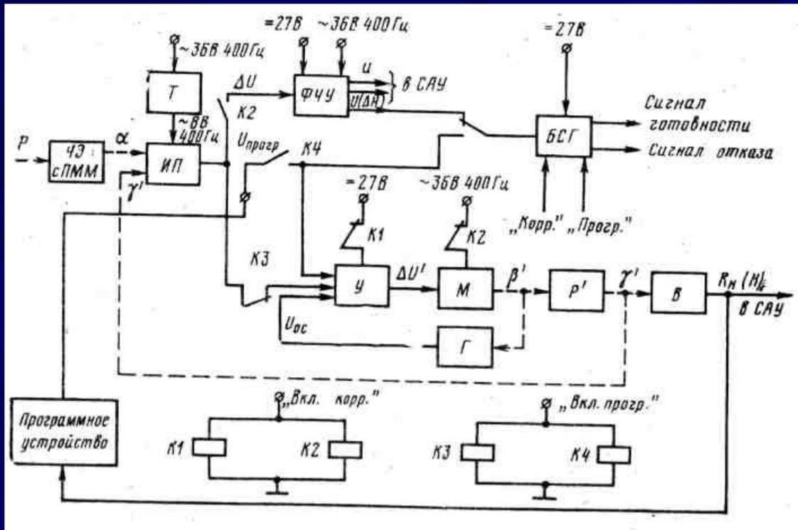
**Режимы работы.** Режим обнуления является подготовительным для включения корректора в режим коррекции. Входное давление  $p$  воспринимается ЧЭ. Элемент ИП преобразует перемещение жесткого центра ЧЭ в напряжение  $\Delta U$ , которое после усилителя  $У$  поступает на управляющую обмотку двигателя  $М$ .
