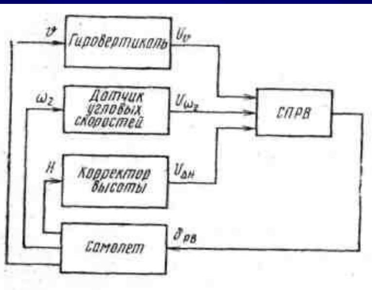
Получение сигнала, пропорционального отклонению самолета от заданной высоты, возможно с помощью корректоров высоты
