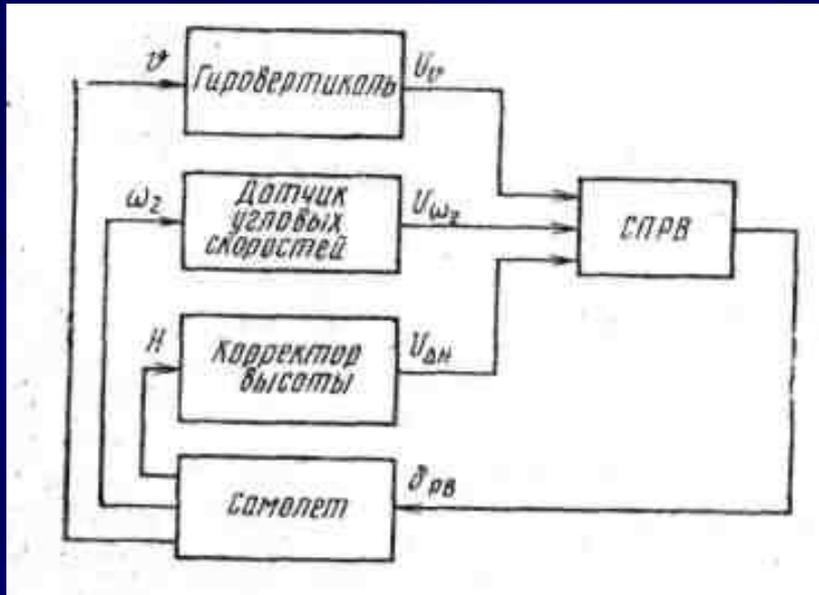
В сервопривод руля высоты СПРВ вместе с сигналами  $Uv$  и  $U\omega_z$ , пропорциональными отклонению угла тангажа и угловой скорости  $\omega_z$ , относительно поперечной оси самолета, от корректора высоты подается сигнал  $U_{\Delta H}$ , пропорциональный отклонению от заданной высоты. Суммарное отклонение  $\delta_{рв}$  руля высоты определяется в этом режиме сигналами  $Uv$ ,  $U\omega_z$ ,  $U_{\Delta H}$ .
