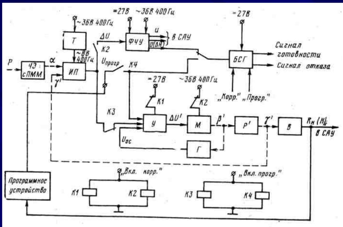
Аналогичны погрешностям электромеханических высотомеров. При выходе из строя отдельных элементов корректора высоты или обрыве в проводах возникают неисправности. Так, обрыв проводов в индукционном преобразователе ИП или в жгуте, подводящем питание, приводит к отсутствию выходных напряжений корректора.
