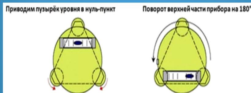
Теодолит устанавливают в рабочее положение, затем поворачивают верхнюю часть на  $180^\circ$ . Если пузырек остался в нуль-пункте (допустимо отклонение до 0,3-0,5 деления ампулы), то условие поверки соблюдено.
