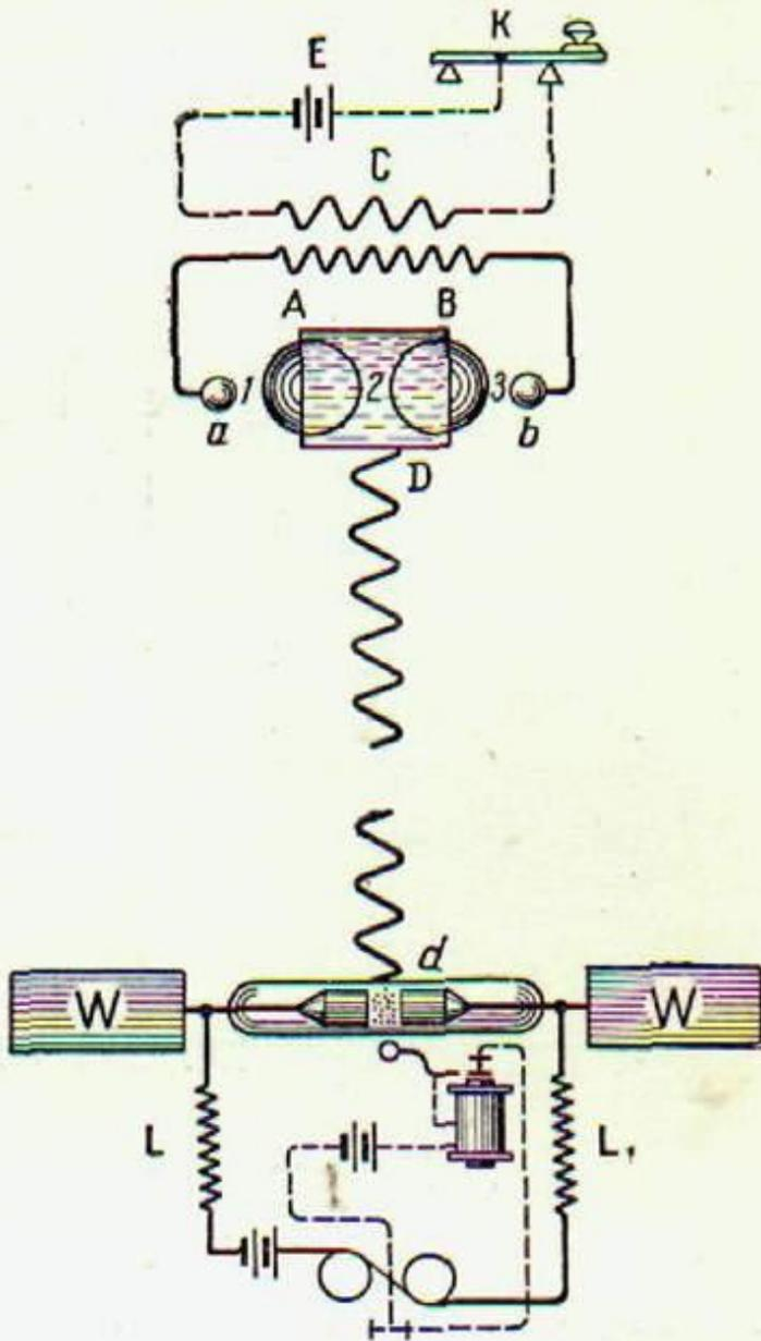
Рис. 117. Схема передатчика и приёмника Г. Маркони
