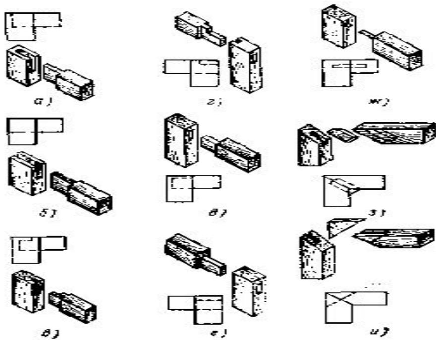
Рис. 95. Основные конструктивные шпиковые соединения брусков под углом:
