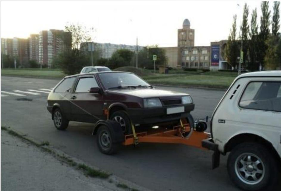
Буксировка частичной погрузкой
