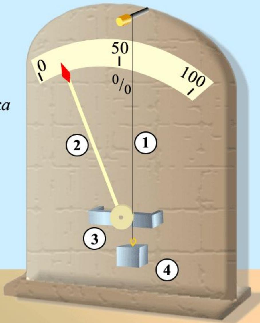
Его действие основано на свойстве человеческого волоса удлиняться при увеличении влажности. Волос (1) наматывается на ролик (3) и растягивается грузом (4). Если влажность возрастает, волос удлиняется и ролик вместе с прикрепленной к ней стрелкой поворачивается. Показания снимаются по шкале.
