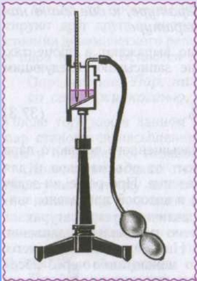
Для измерения точки росы применяют специальный прибор, называемый **конденсационным гигрометром**. Основной его частью является сосуд, передней стенкой которого служит металлическое зеркальце. Внутри этого сосуда наливают эфир, а сверху вставляют термометр. При продувании через него воздуха эфир испаряется и охлаждает стенки сосуда. Измеряя температуру, при которой зеркальце покрывается капельками воды (конденсирующейся из окружающего воздуха), определяют точку росы  $t_p$ .
