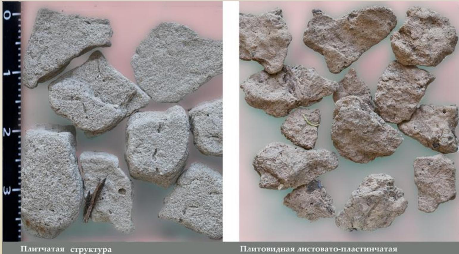
**Рис. 16. Плитчатая и листовато-пластинчатая структура**
