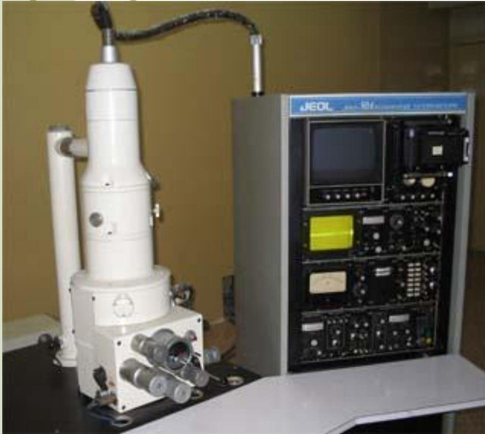
Сканирующий электронный микроскоп:
