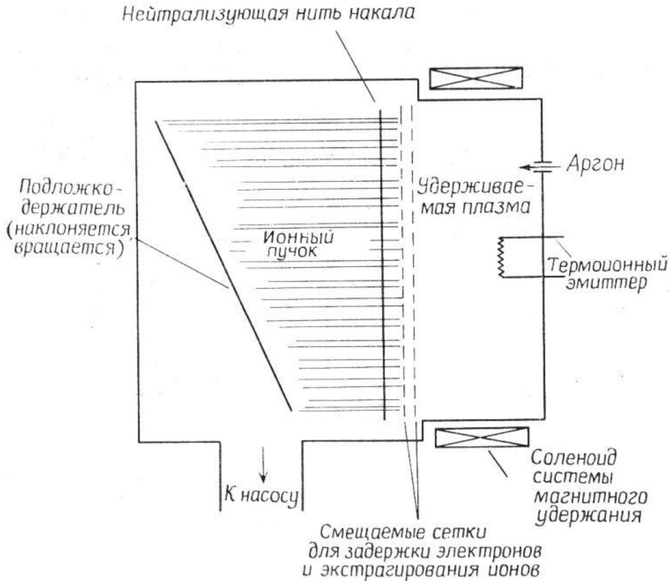
Рис. 8.12. Система для ионно-лучевого травления.
