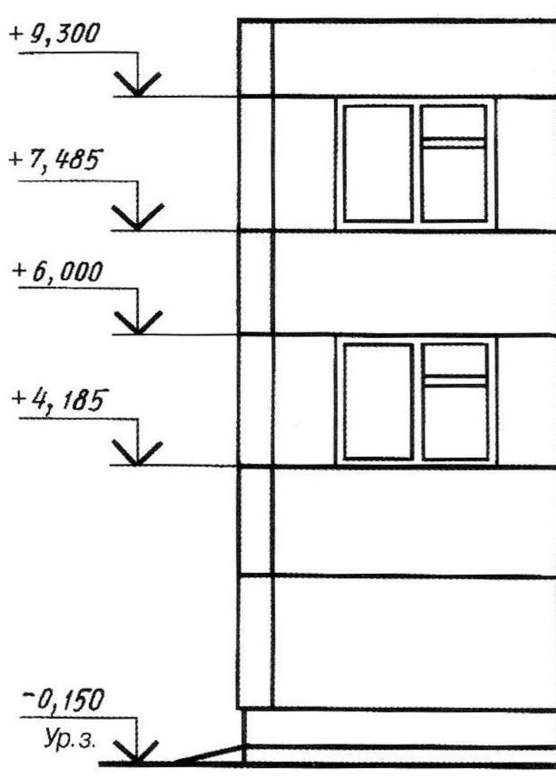
Условные отметки уровней (высоты, глубины) на планах, разрезах, фасадах показывают расстояние по высоте от уровня поверхности какого-либо элемента конструкции здания, расположенного вблизи планировочной поверхности земли. Этот уровень принимается за нулевой.
