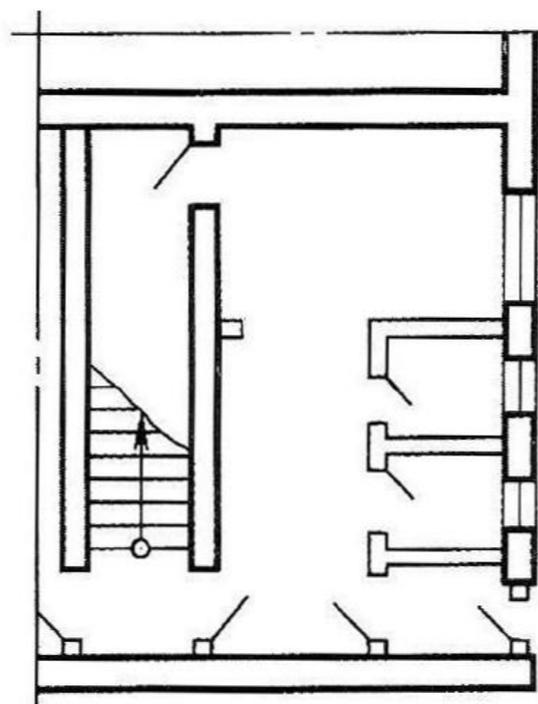
Контурь участков стен, не попавшие в плоскость сечения, обводят тонкой линией
