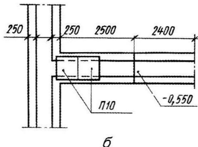
На строительных чертежах **отметки уровней указывают в метрах с тремя десятичными знаками, отделёнными от целого числа запятой.**
