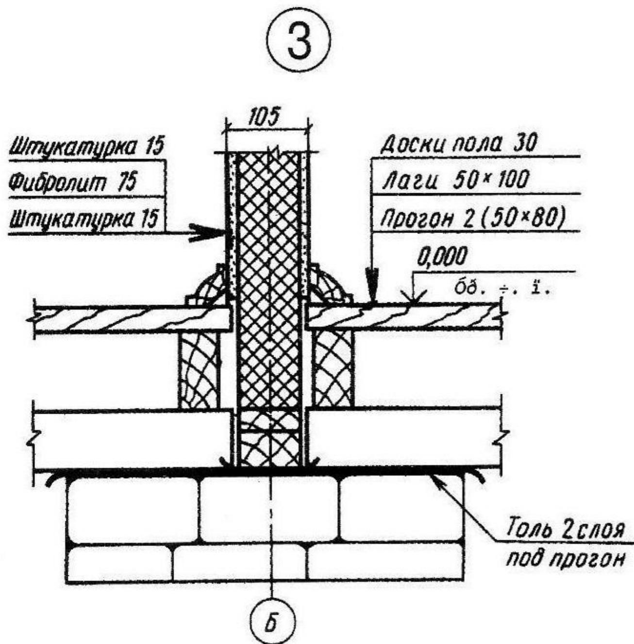
Внутри кружка ставят цифру, обозначающую номер узла. **Кружок с номером узла рекомендуется размещать над выносным элементом или справа от него**
