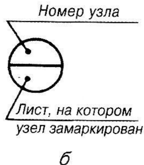
Сопровождающие тексты, таблицы, выноски, ссылки, примечания. Выноски и ссылки на строительных чертежах
