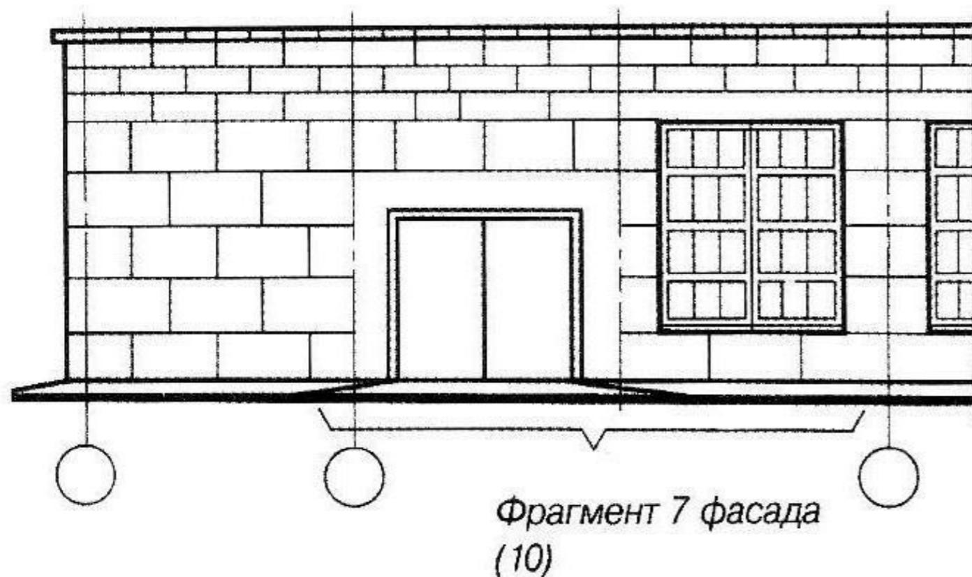
**Фрагменты на фасадах и планах** зданий или сооружений **обозначают фигурной скобкой**. Под фигурной скобкой, а также над соответствующим фрагментом наносят его наименование, например: **«Фрагмент фасада»**.
