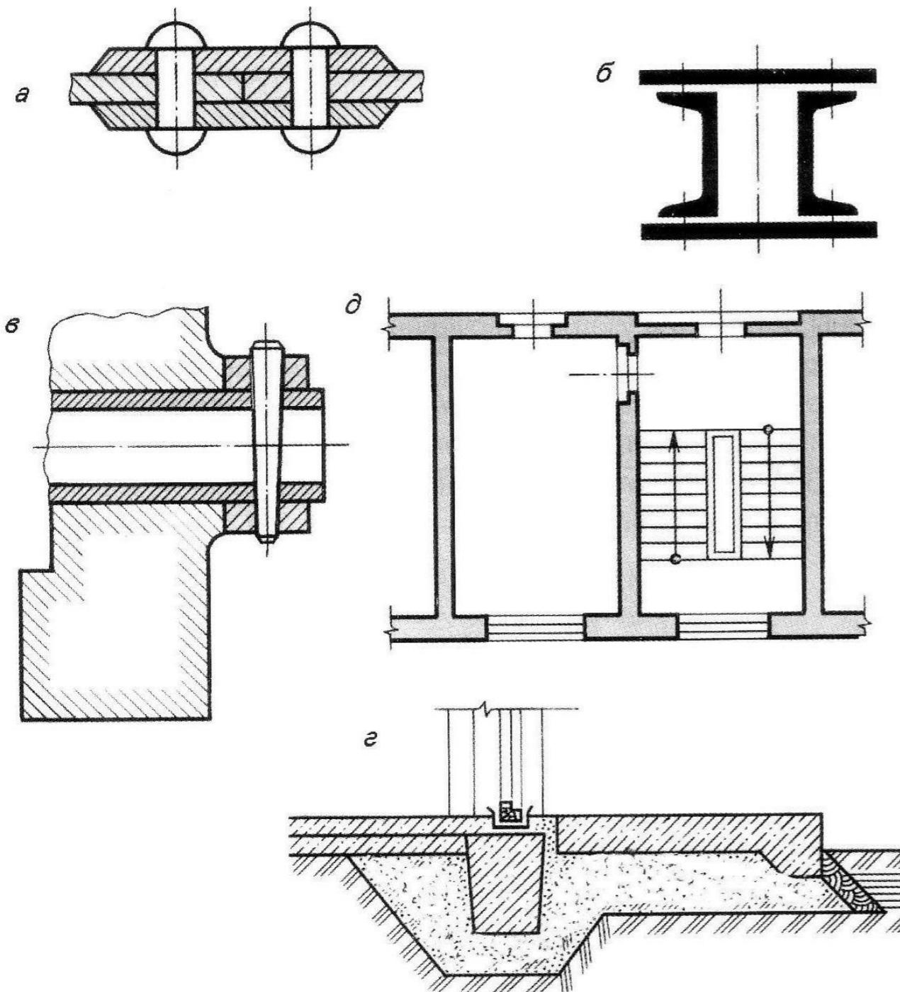
Если три различные детали соприкасаются друг с другом, следует изменять расстояние между линиями в штриховке или сдвигать эти линии в одном сечении по отношению к другому, не изменяя угла их наклона.
