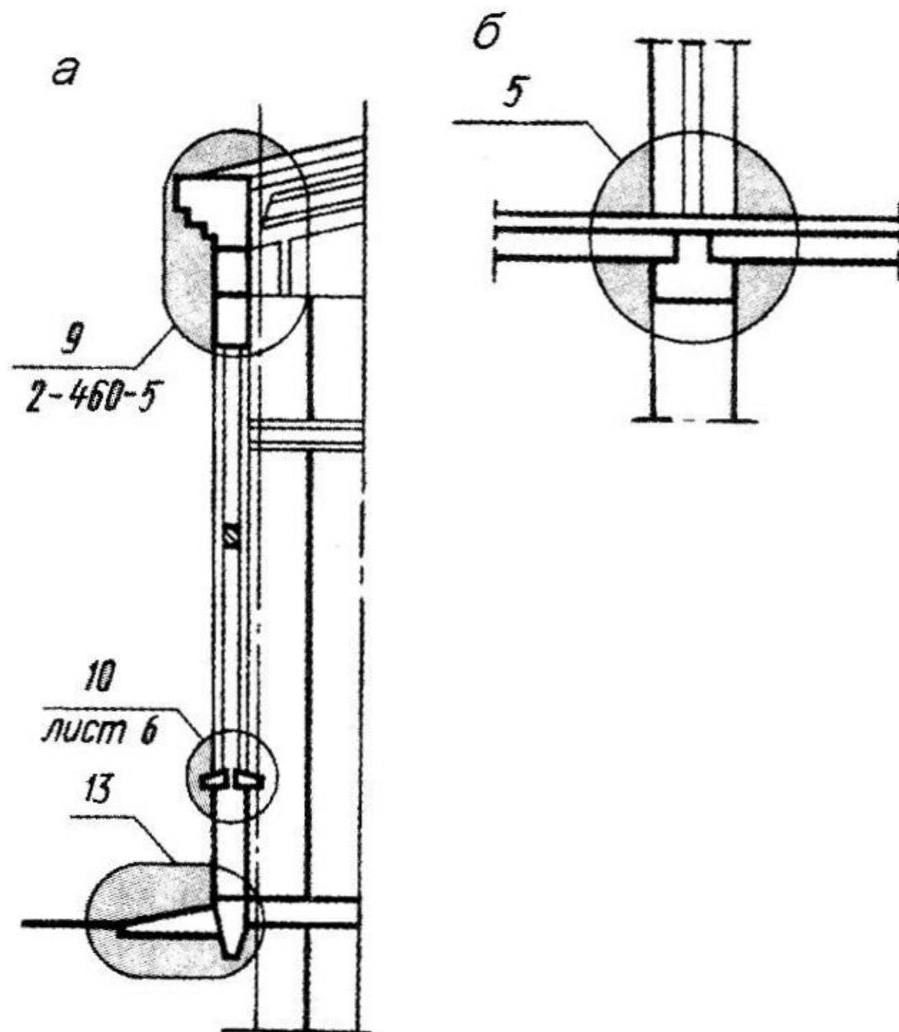
При выполнении чертежей узлов то место, которое необходимо показать на выносном элементе, отмечают на виде (фасаде), плане, разрезе **замкнутой сплошной тонкой линией (окружность или овал) с указанием на полке линии-выноски порядкового номера выносного элемента арабской цифрой**. Если на полке линии-выноски стоит одна цифра, это значит, что выносной элемент расположен на том листе, что и основной чертёж
