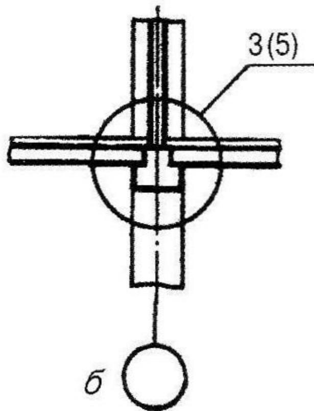
Если узел (выносной элемент) размещён на другом листе основного комплекта рабочих чертежей, то под полкой линии-выноски **указывают лист, на котором помещён узел**. Номер листа может быть указан на полке линии-выноски **рядом с номером узла в скобках**
