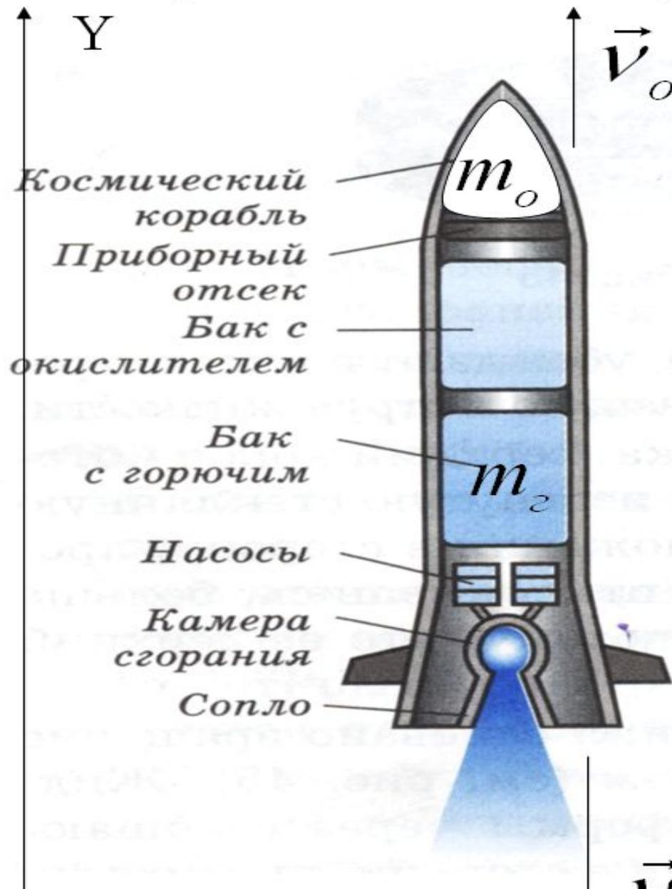
Реактивное движение – следствие закона сохранения импульса.
