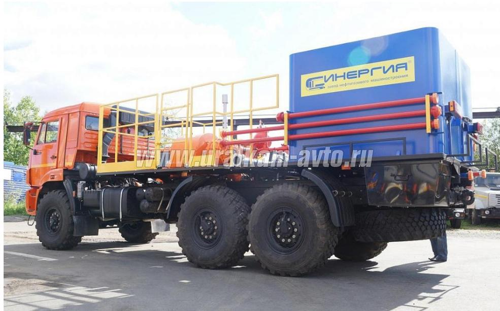
Агрегат цементирующий СИН-35 предназначен для нагнетания различных жидких сред при цементировании скважин в процессе их бурения, текущего и капитального ремонта.
