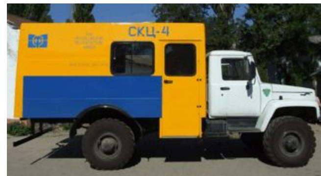
Предназначена для непрерывного контроля важнейших технологических параметров процесса цементирования скважин в реальном масштабе времени
