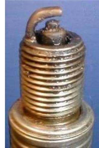
На свече наблюдается масло и следы несгоревшего бензина, что говорит о неработающем цилиндре двигателя, а также о нестабильной работе, увеличенном расходе топлива.
