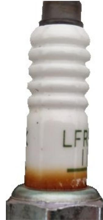
На изоляторе свечи наблюдается коричневый налёт, что свидетельствует о коронном разряде при работе свечи.
