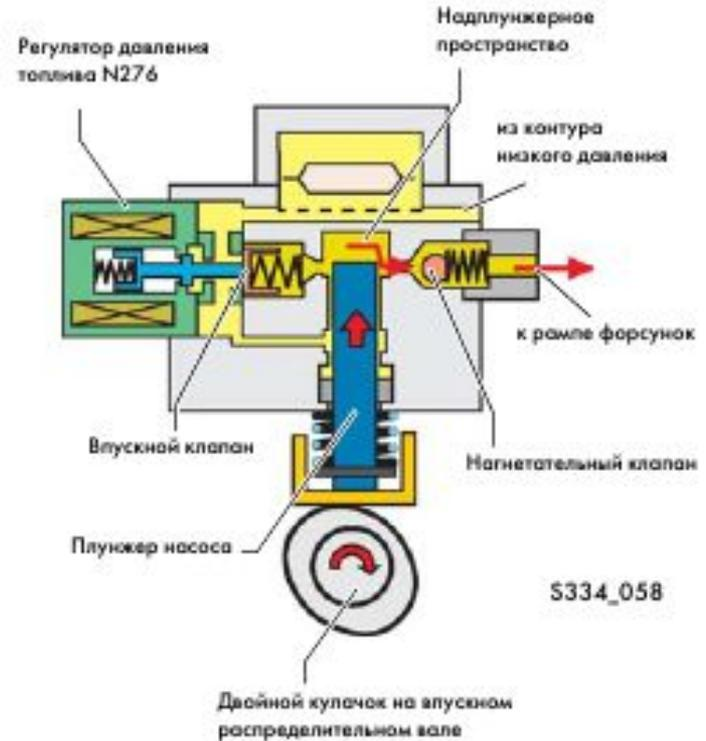
В расчетный момент движения плунжера регулятор давления закрывает впускной клапан, после чего начинается подача топлива к форсункам.
