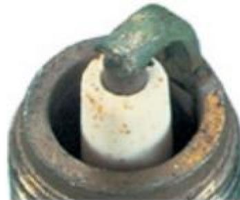
Синий оттенок электрода свечи свидетельствует о перегреве двигателя.
