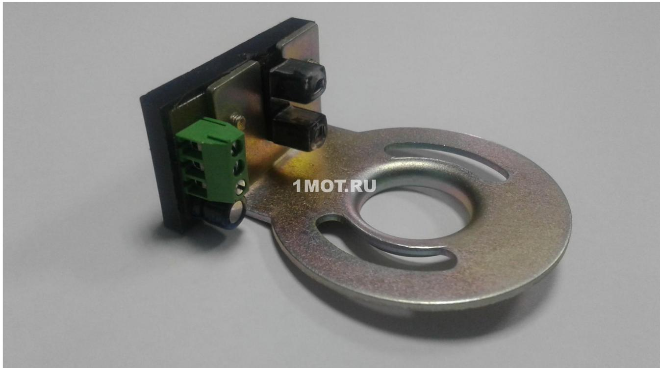
Оптический датчик (такая модификация системы называется TI-o) – представляет из себя сегментированный диск, закрепленный на валу распределителя, который перекрывает инфракрасный луч, направленный на фототранзистор.
