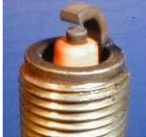
Нормальная свеча. Цвет: серо-коричневый, нет никаких признаков плохой работы двигателя, топливной системы и т.д. Слегка изношен электрод
