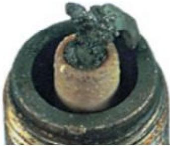
Разрушен центральный электрод, что является следствием калильного зажигания
