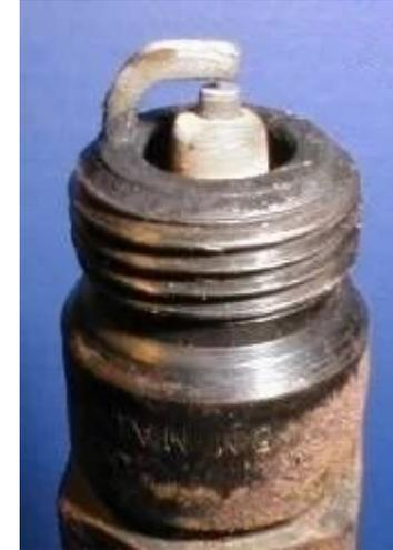
Смесь бедная, это грозит перегревом свечей а также камер сгорания. Возможен перегрев выпускных клапанов.
