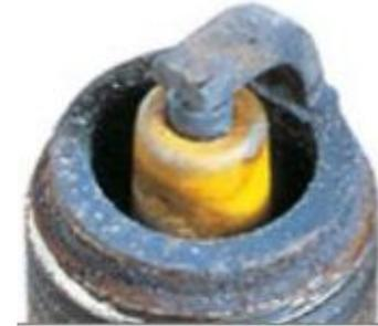
На изоляторе свечи наблюдается жёлтый налёт, что свидетельствует о наличии свинца в топливе.
