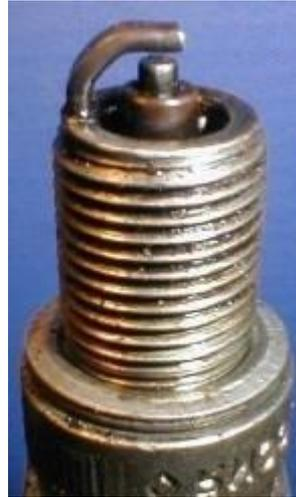
Износ маслосъёмных колпачков и прочих маслосодержащих деталей. Серый цвет отработавших газов.
