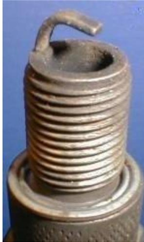
Разрушен центральный электрод и юбка, что является следствием детонации двигателя, из-за некачественной свечи, или низкооктанового бензина
