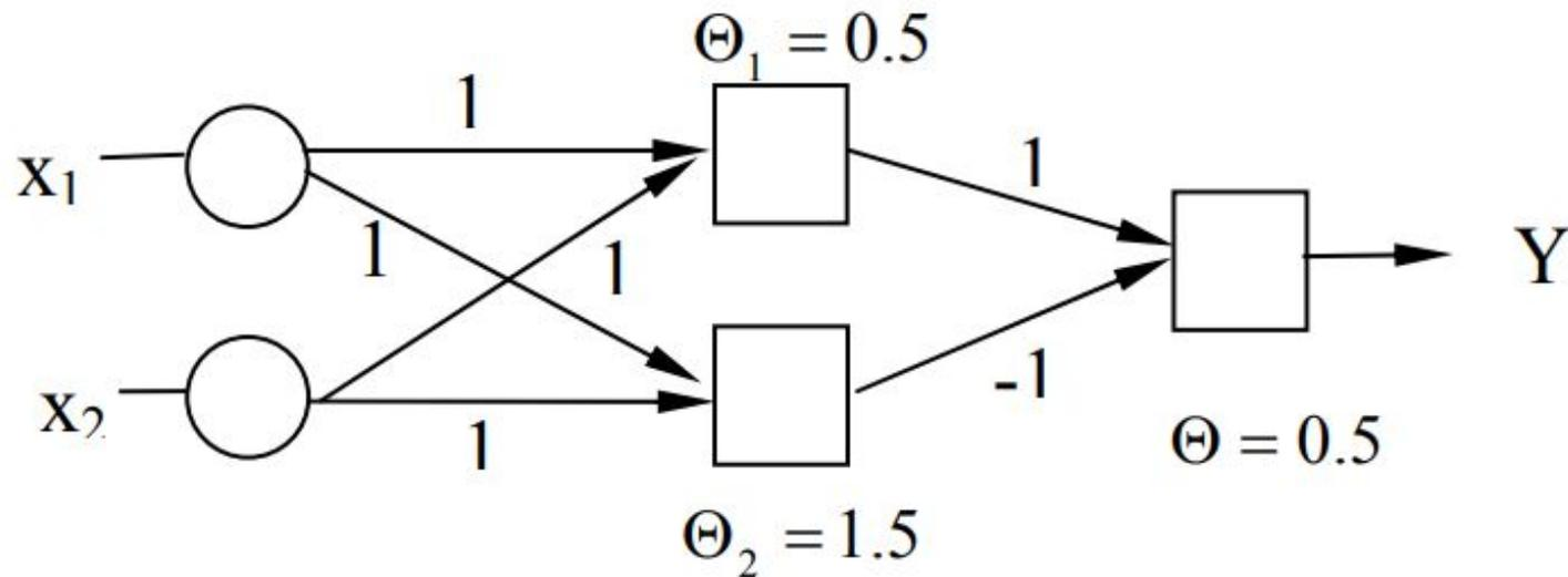
Здесь  $s_1 = x_1 * w_{11} + x_2 * w_{21}$  – значение, поступающее на вход первого нейрона первого слоя,  $s_2 = x_1 * w_{12} + x_2 * w_{22}$  – вход второго нейрона первого слоя;  $y_1, y_2$  – выходы соответствующих нейронов первого слоя;  $S$  – входное значение нейрона второго слоя;  $Y$  – выход сети.
