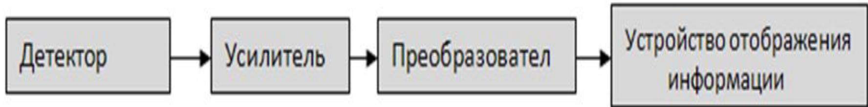
Блок-схема устройства контроля радиоактивности
