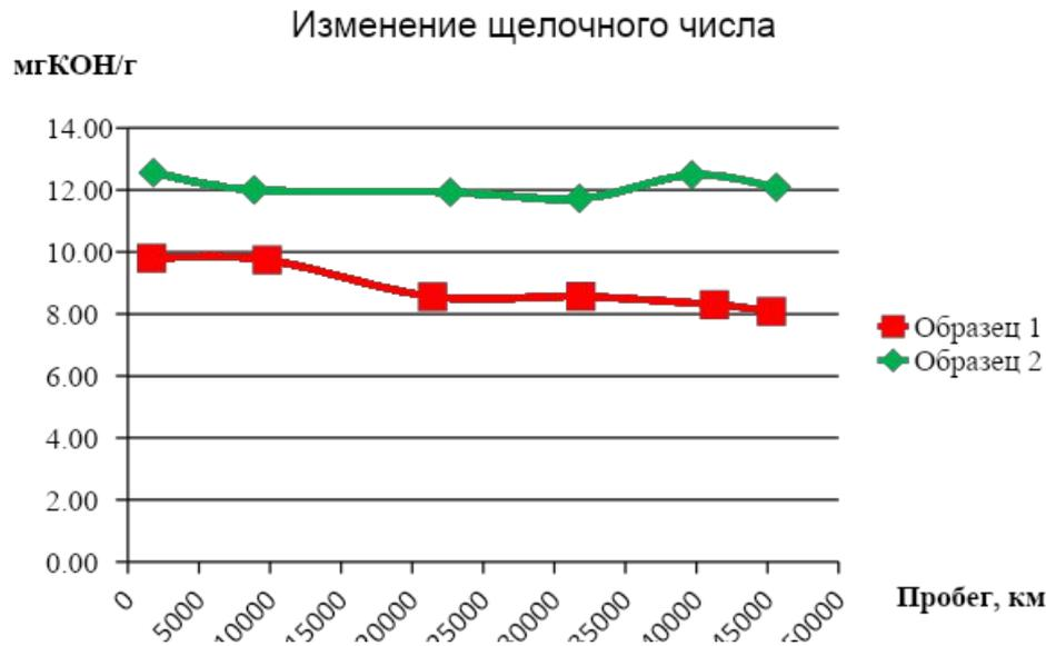
Изменение щелочного числа, позволяет судить о стабильной работе присадочного комплекса моторного масла
