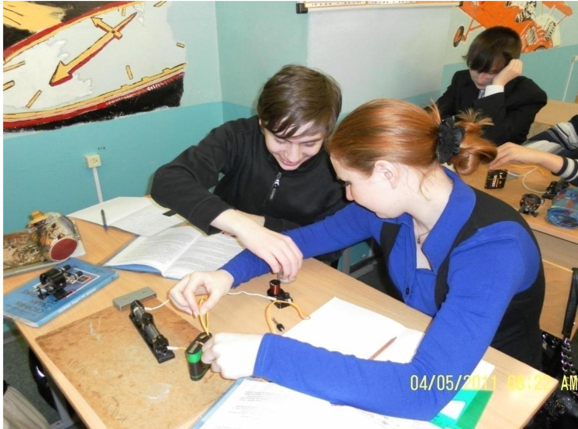
Исследование магнитного поля прямого проводника и катушки с током.
