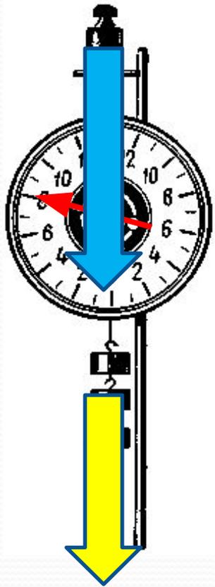
Модуль равнодействующей сил равен **сумме** модулей всех действующих сил, если они направлены вдоль одной прямой и **в одну сторону**.
