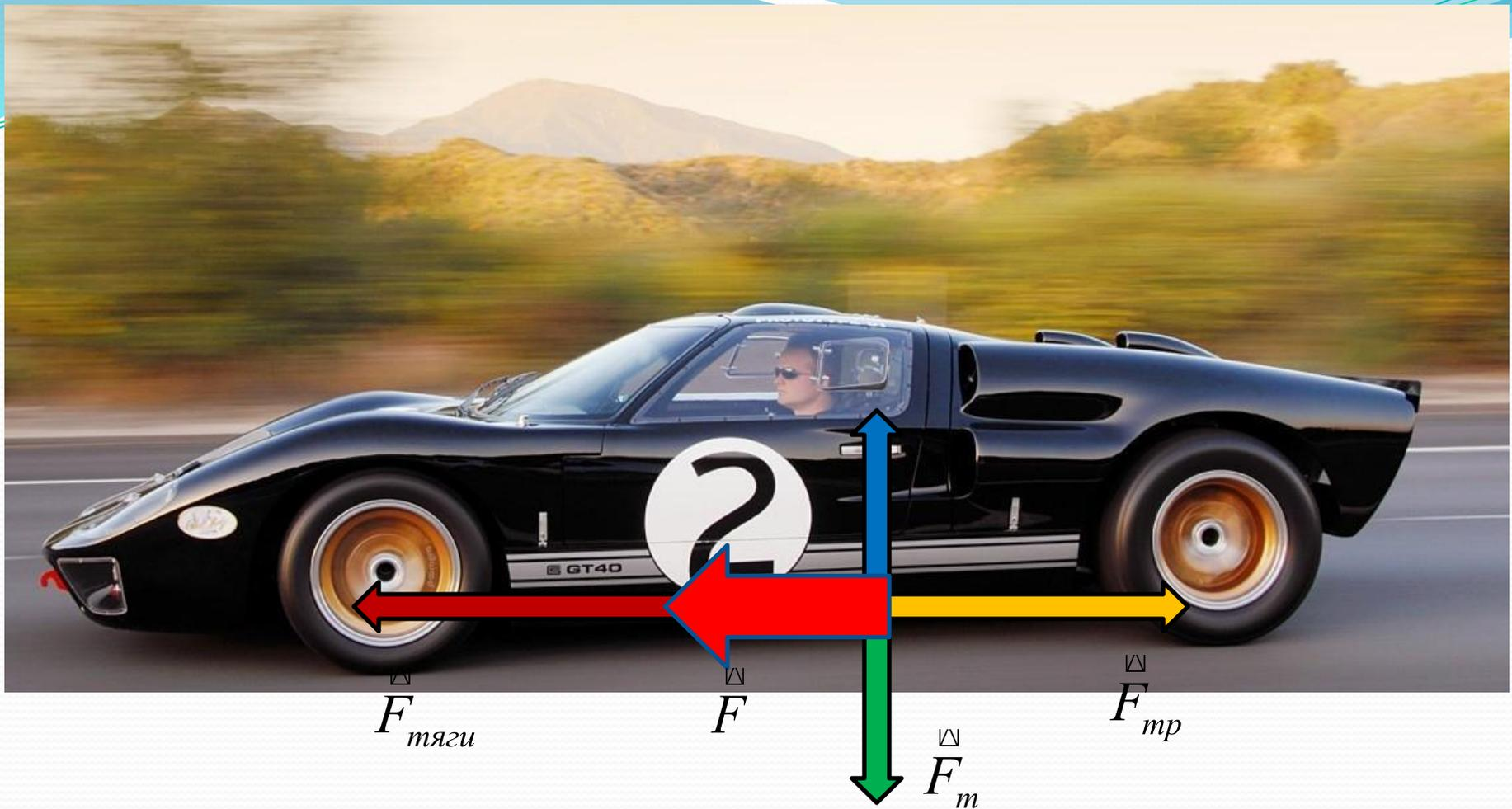
**Силу**, которая производит на тело такое же действие, как несколько одновременно действующих сил, называют **равнодействующей** этих сил.
