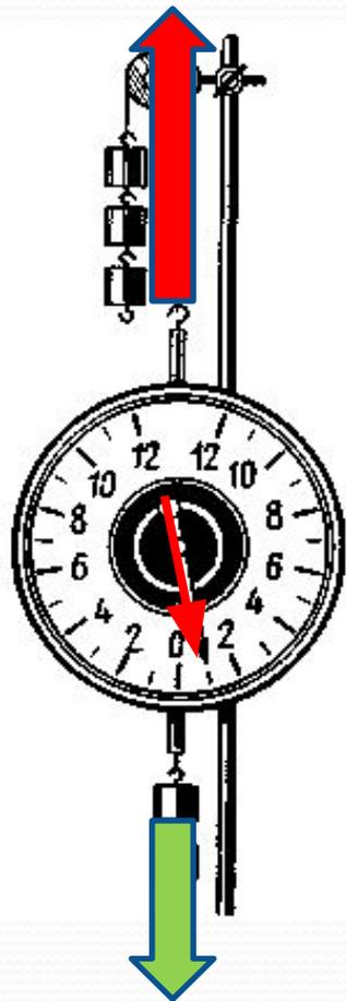
Модуль равнодействующей сил равен **разности** модулей действующих сил, если они направлены вдоль одной прямой и **в противоположные стороны**. Направлена равнодействующая в этом случае **в сторону большей** по модулю силы.
