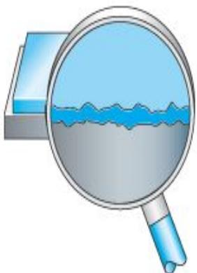
При наличии смазки соприкасаются не сами поверхности тел, а ее соседние слои. Трение между слоями жидкости слабее, чем между твердыми поверхностями.
