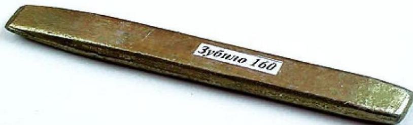
Зубило применяют для удаления рубкой слоя металла, разрубания на части заготовок листового материала.
