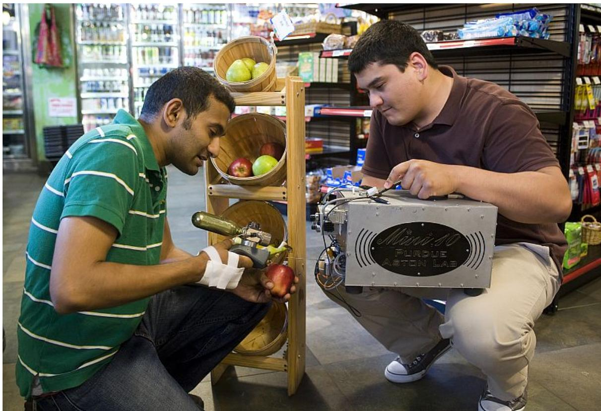
Масс-спектрометр в продуктовом магазине за считанные минуты определил химические вещества на яблоках и апельсинах
