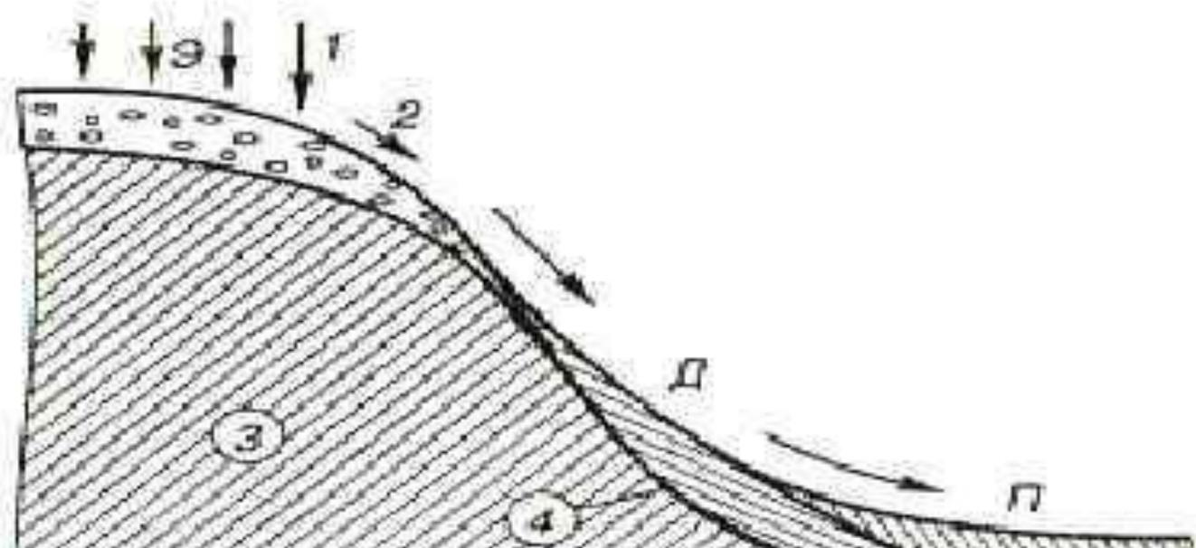
**Схема образования наносов на склоне рельефа**
