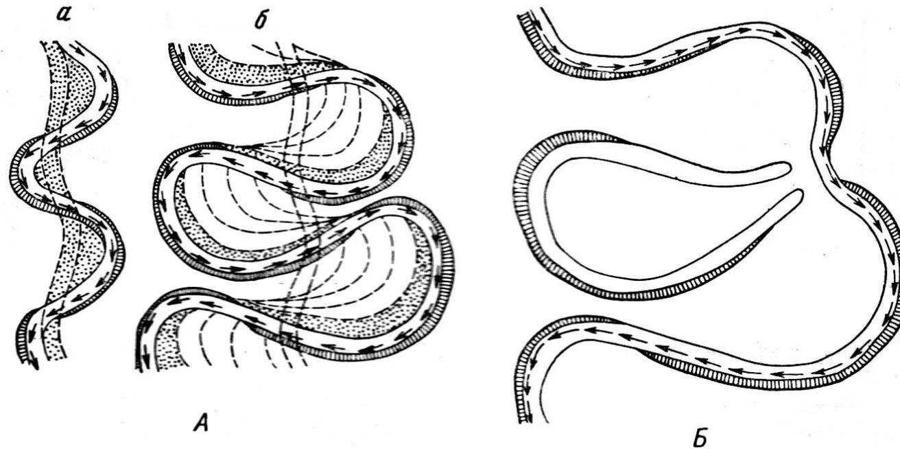
Рис. 7.16. А. Схема последовательного смещения речных меандр по мере их роста: *a* — начальная стадия; *б* — последовательные положения в более поздних стадиях. Б. Образование старицы
