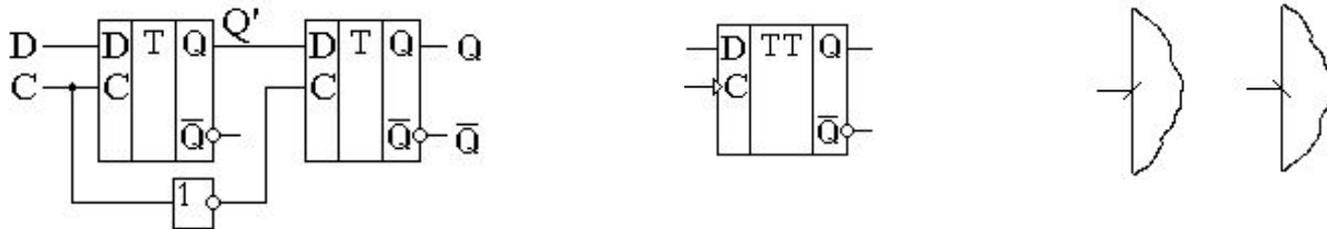
Рисунок 6 – Схема D-триггера, работающего по
