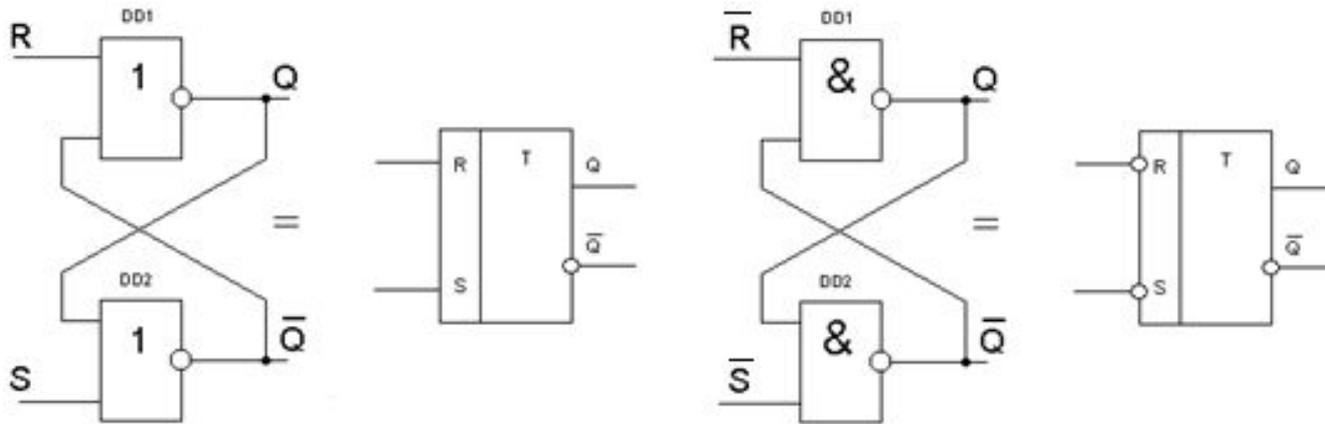
Рисунок 1 – Асинхронный RS-триггер
