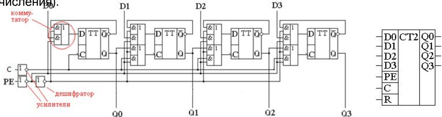
Рисунок 12 – Счётчик, с возможностью параллельной записи двоичных кодов и его УГО
