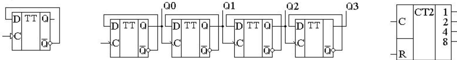
Рисунок 10 – Схема четырехразрядного счётчика, построенного на универсальных D-триггерах и его УГО
