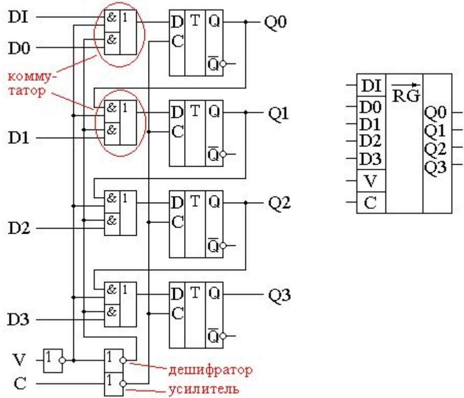
Рисунок 9 – Схема универсального регистра и его УГО
