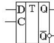
Рисунок 3<sup>В)</sup> Синхронный D-триггер. А) принципиальная схема, б) преобразование синхронного RS-триггера в D-триггер, в) УГО D-триггера
