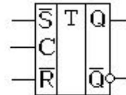
Рисунок 2 – Синхронный RS-триггер
