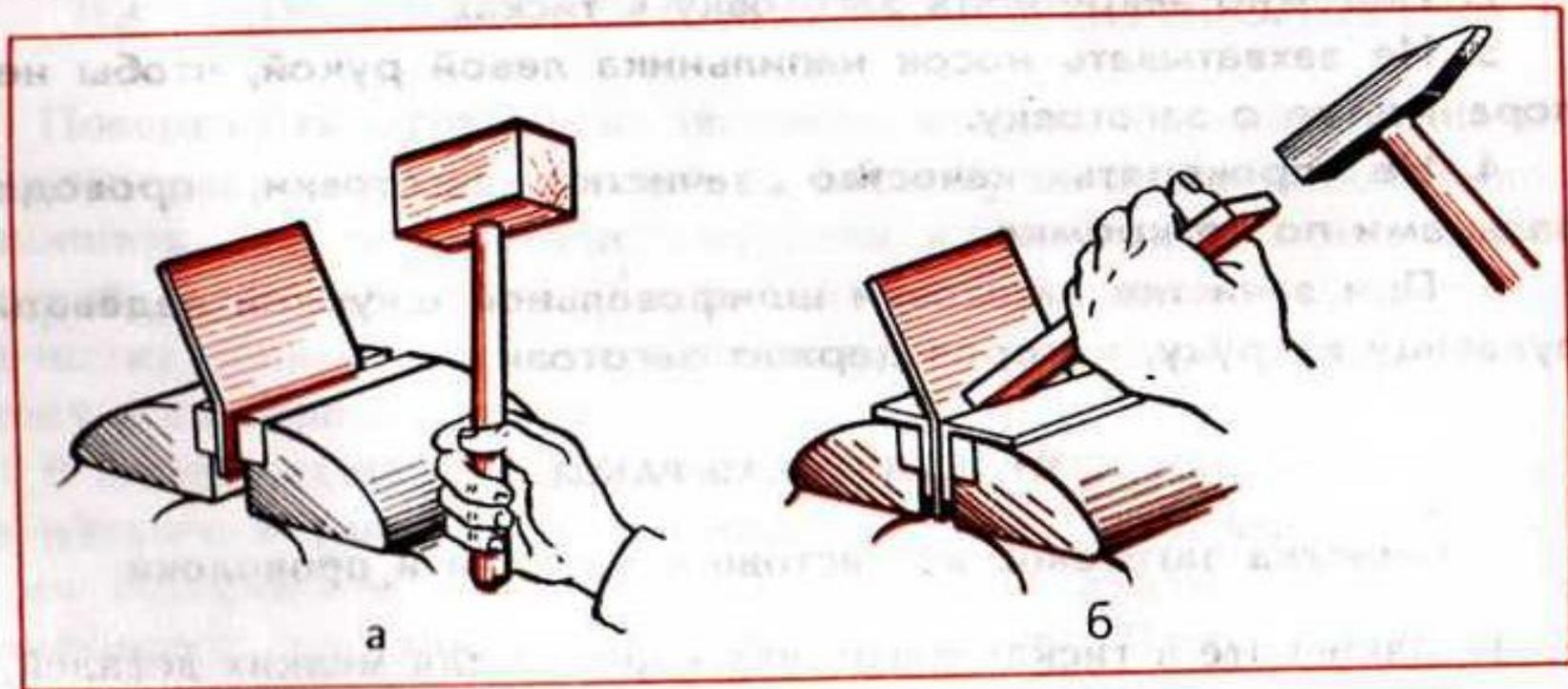
Рис. 74. Сгибание заготовок из тонколистового металла в тисках:
